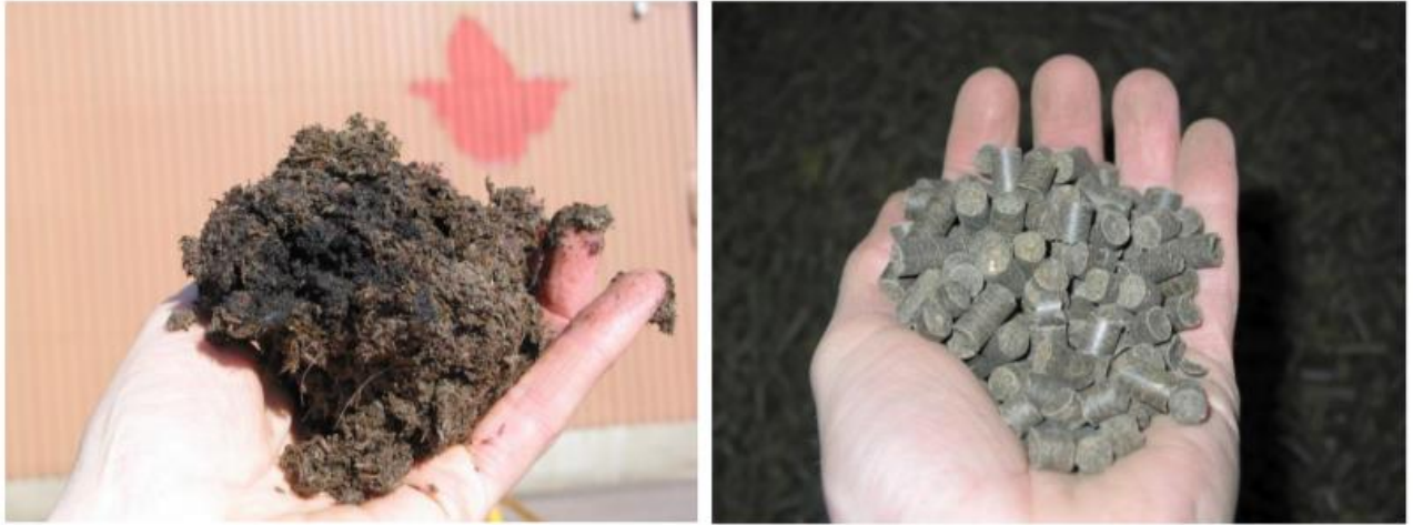
Figur 36: Tv. Uforarbejdet fiber af dekanter-centrifugeret fiber. Th. Tørret og pelleteret fiber. Fotos: Torkild Birkmose, SEGES Innovation. Kilde: (Birkmose, et al., 2019).
