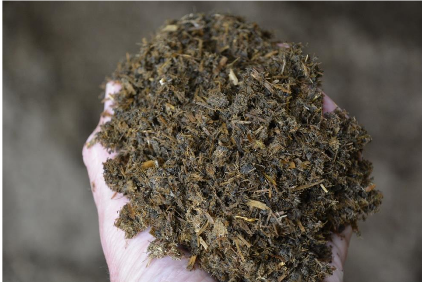
Figur 46: Fiberfraktion efter separation af afgasset biomasse med en skruepresse og en dekantercentrifuge. Foto: Torkild Birkmose, SEGES Innovation
