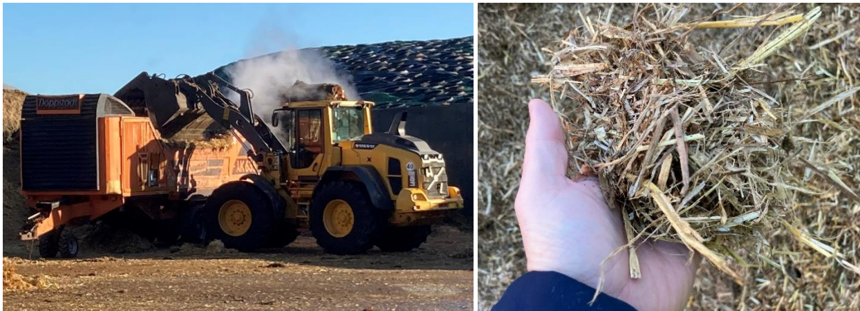
Figur 44: Tv: knuser til neddeling af halm. Th: knust halm. Fotos: Lars V. Toft, SEGES Innovation
