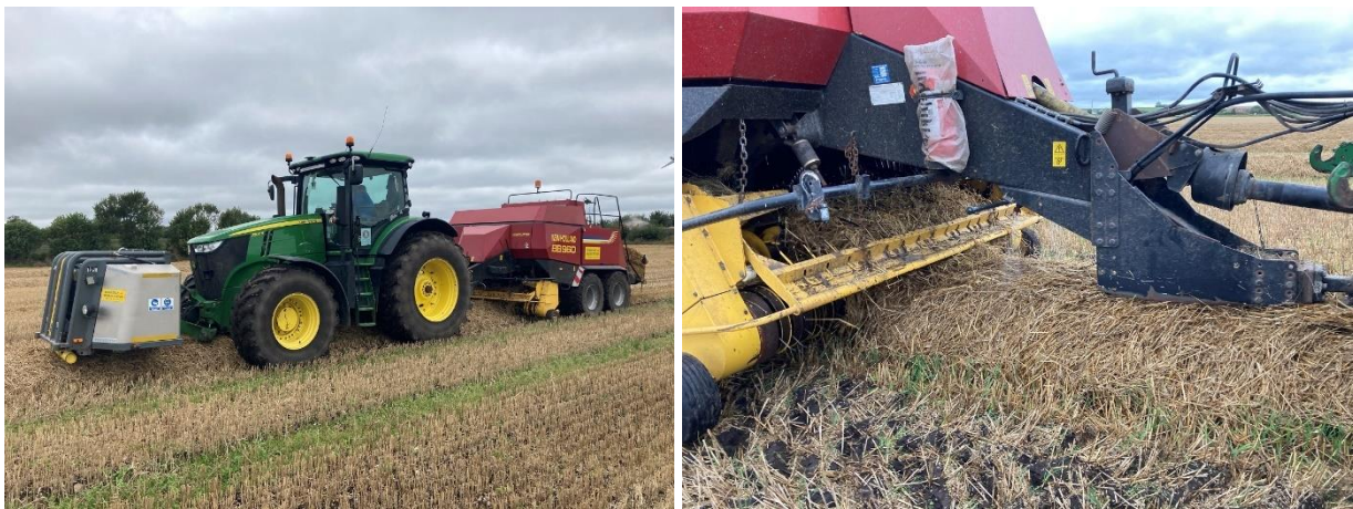
Figur 11: Presning af våd halm til biogasproduktion hos Skinnerup Maskinstation i EUDP-projektet StrawSilage. Til højre ses dyser, der udsprøjter ensileringsmiddel på halmskåret lige foran presserens pick-up. Foto: Søren Ugilt Larsen, Teknologisk Institut.
