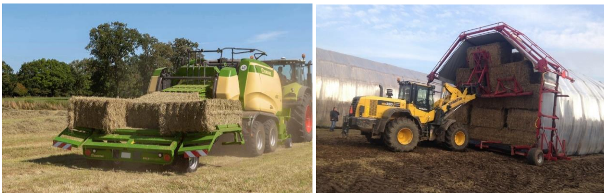
Figur 31: Tv. HD-presser med opsamlervogn. Foto: Brøns Group. Th. Markstak lavet efter Pomi Wrap 12-princippet Foto: Pomi Industri.
