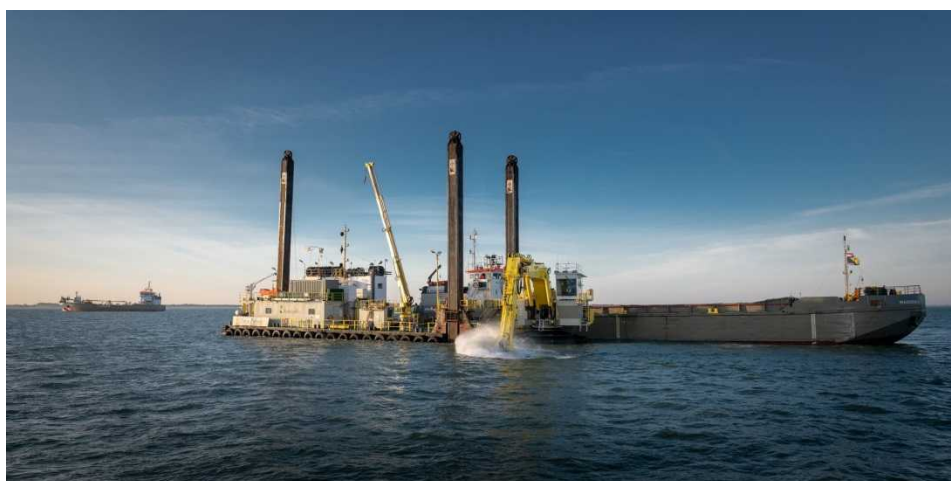
Figur 4.9: Øverst: Grab på en pram. Nederst: Rendegraver på pram
