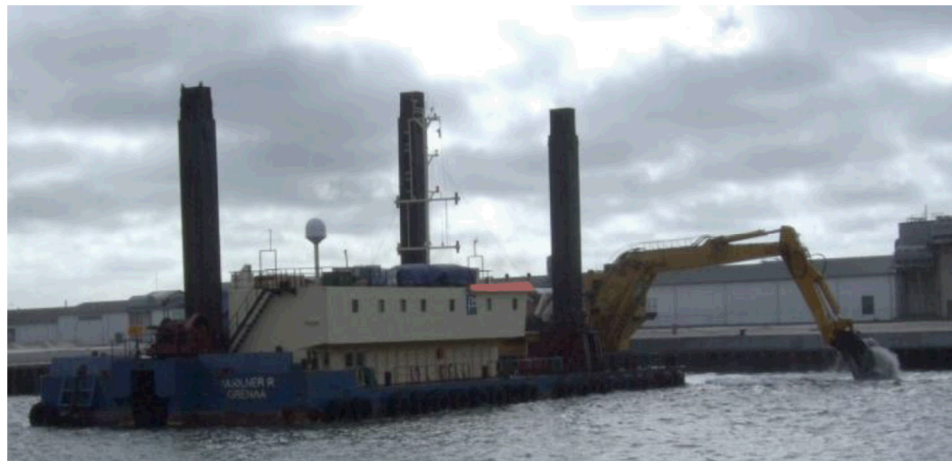
Figur 6.57: Her ses et eksempel på en back-hoe dredger, som er typen af fartøj, der er brugt til støjberegningerne.
