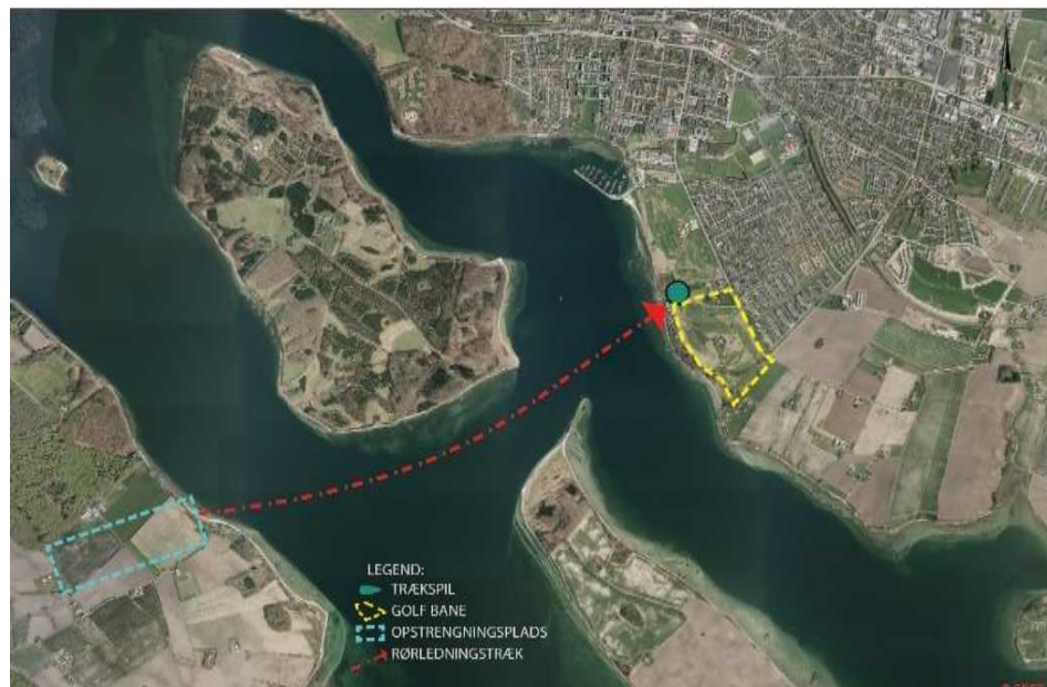
Figur 4.3: Principskitse for rørledningsinstallation ved trækspil.
