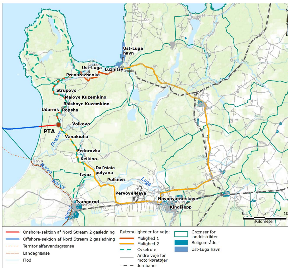
Figur 14.1 Vejruiter, der skal bruges til transport af udstyr og materialer til NSP2-området med grisesluse og arbejdsstedet.
