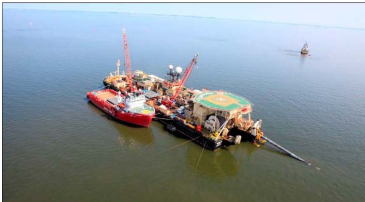
Figur 6-22 Typisk læggepram til lavt vand (med ankerbåd og fartøj til rørtransport).
