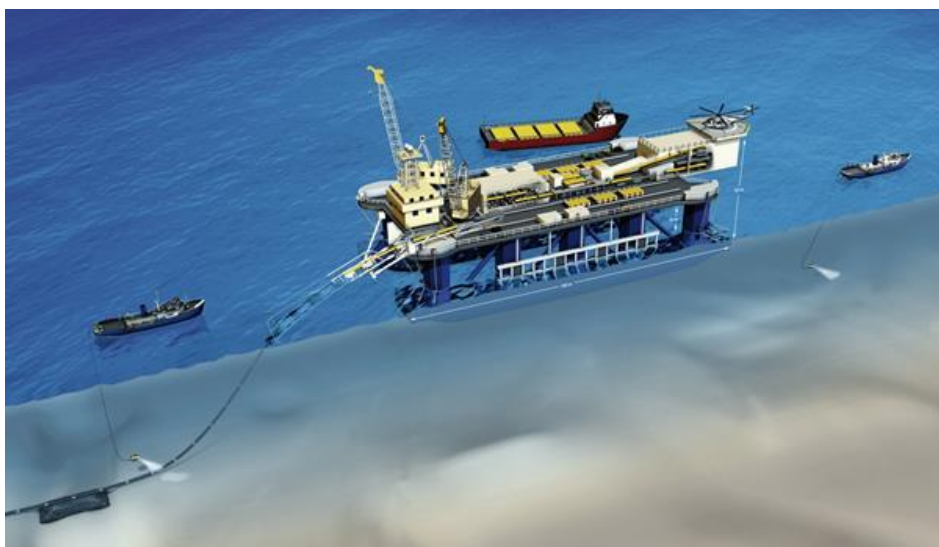
Figur 6-15 Rørlægningsfartøjet til s-lægning og undersøgelseshjælpesfartøjer.
