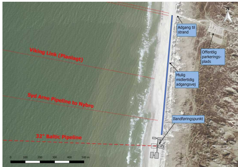
Figur 6.37: Kommende og eksisterende rørledninger/kabler, der er eller vil blive ilandført i nærheden af Baltic Pipe-rørledningen i Nordsøen. For Baltic Pipe der anlægsplads og midlertidig adgangsvej på stranden anført på kortet.
