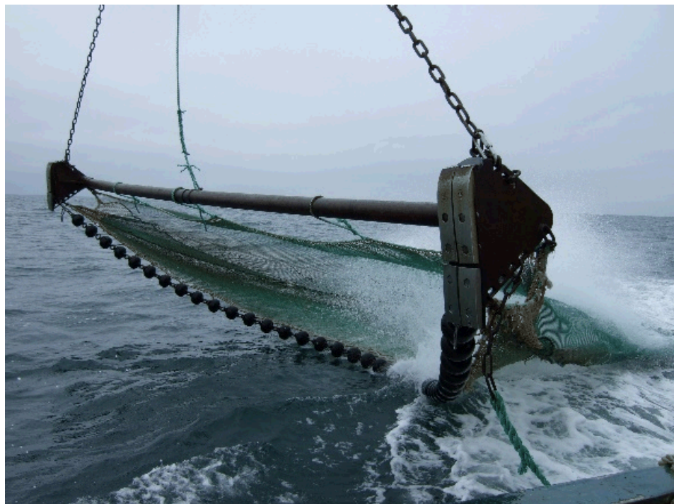
Figur 6.21: Bomtrawl på dansk hestereje-bomtrawler (Foto: Carsten Krog).
