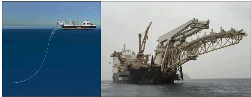
Figur 4.4: På figuren til venstre ses en illustration af, hvordan rørledningen sænkes fra rørledningsfartøjet og danner den S-form, som læggeteknikken er opkaldt efter. Billedet til højre viser et eksempel på et rørledningsfartøj.
