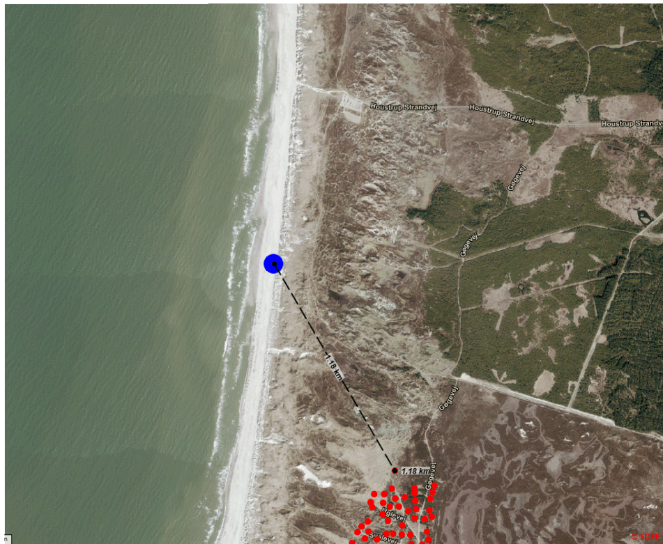
Figur 6.36: Ilandføringspunkt for Baltic Pipe-rørledningen er markeret med en blå prik og nærliggende beboelser er markeret med rød signatur. Afstanden til nærmeste beboelse er cirka 1,2 km.
