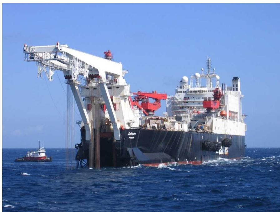
Figur 4.6: Eksempel på dynamisk positioneret rørledningsfartøj.
