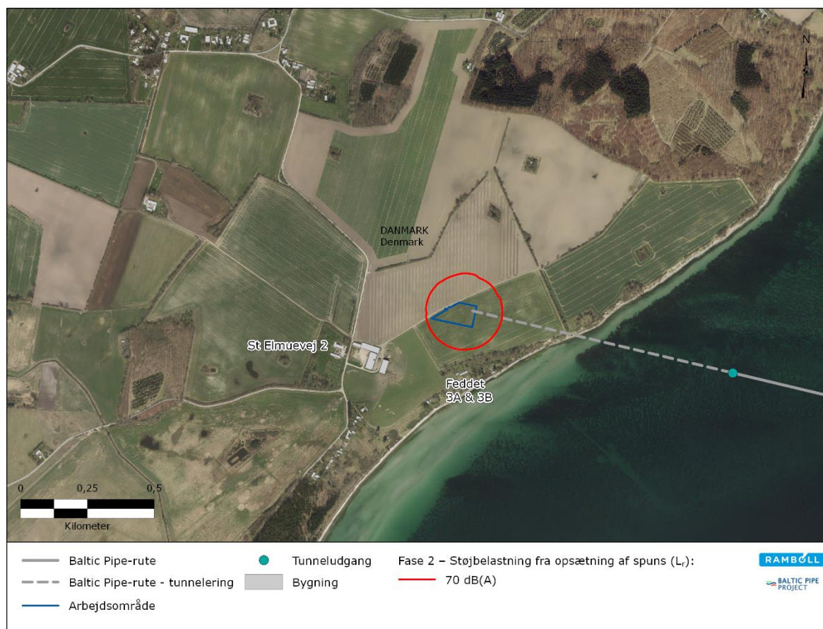
Figur 9-33 Støjkort for fase 2 – Pilotering af spunsvægge og udgravning (startskakt) (1-2 ugers varighed), der viser støjkonturen for niveau 70 dB(A). Pilotering af spunsvægge forventes at finde sted inden for normal arbejdstid, hvor den anvendte vejledende grænseværdi er 70 dB(A). Støjkonturen 40 dB(A) er ikke vist, da den primært forekommer uden for kortets udstrækning.
