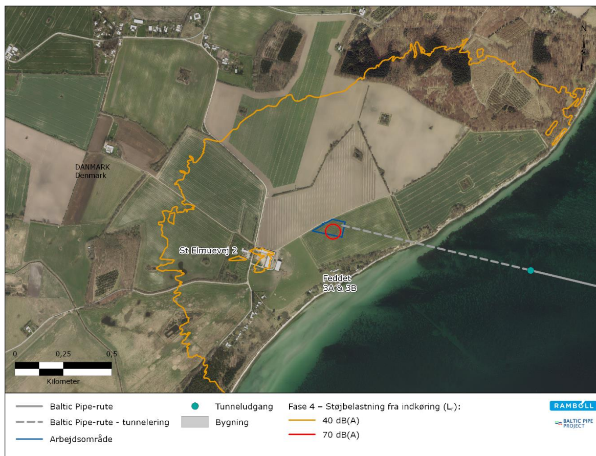
Figur 9-35 Støj kort for fase 4, før-idriftsættelse (to måneder), der viser støjkonturerne for niveauerne 40 dB(A) og 70 dB(A). Aktiviteterne i denne fase vil finde sted 24 timer i døgnet.
