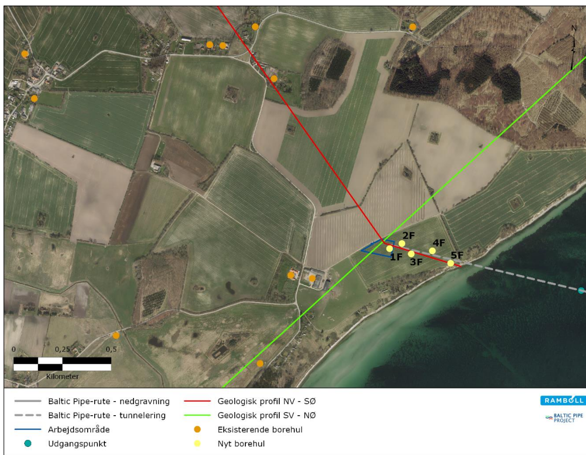
Figur 9-28 Placering af boringer og geologiske profiler.
