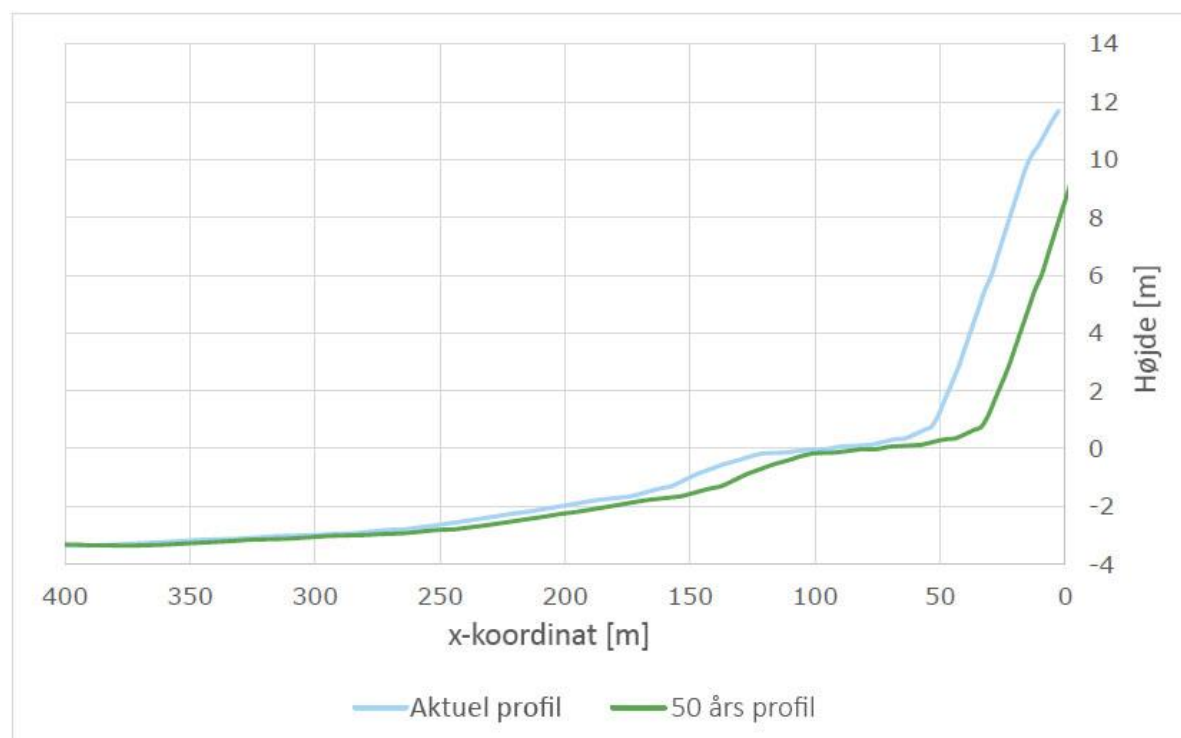
Figur 3-13 Den aktuelle kysttværprofil ved Faxe S vist sammen med profilen efter 50 år, som den er udregnet ved hjælp af geomorfologiske modeller (Rambøll, 2018e).
