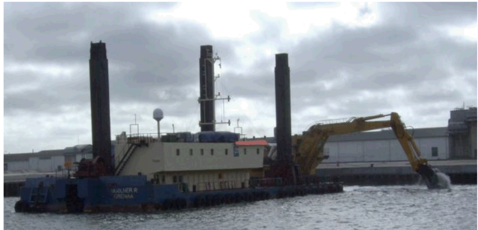
Figur 1.5: Viser et eksempel på en backhoe dredger, som er typen af fartøj der er brugt til beregningerne på vandet.
