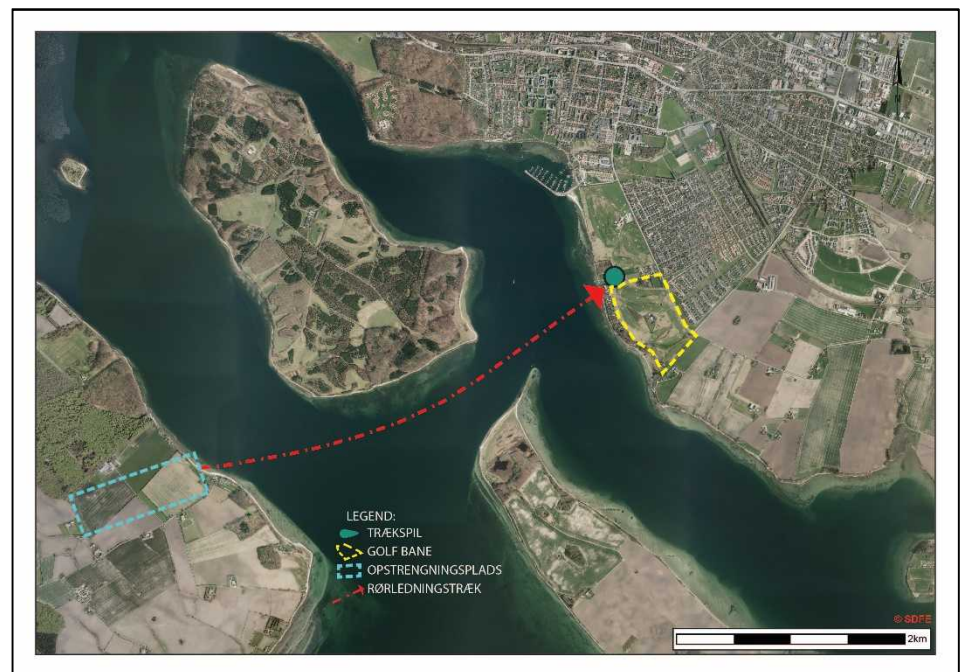
Figur 1.4: Situationsplan for anlægsarbejdet.
