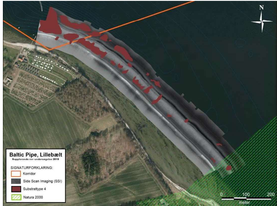
Figur 6.72: Kortudsnit fra undersøgelseskorridentens vestlige del samt området ned mod Natura 2000-området langs Jyllandssiden. På kortet ses udbredelsen af stenrev (substrattype 4). Kortlægningen er foretaget på baggrund af feltundersøgelsen i efteråret 2018 (RUF Dykkerservice, 2018b).
