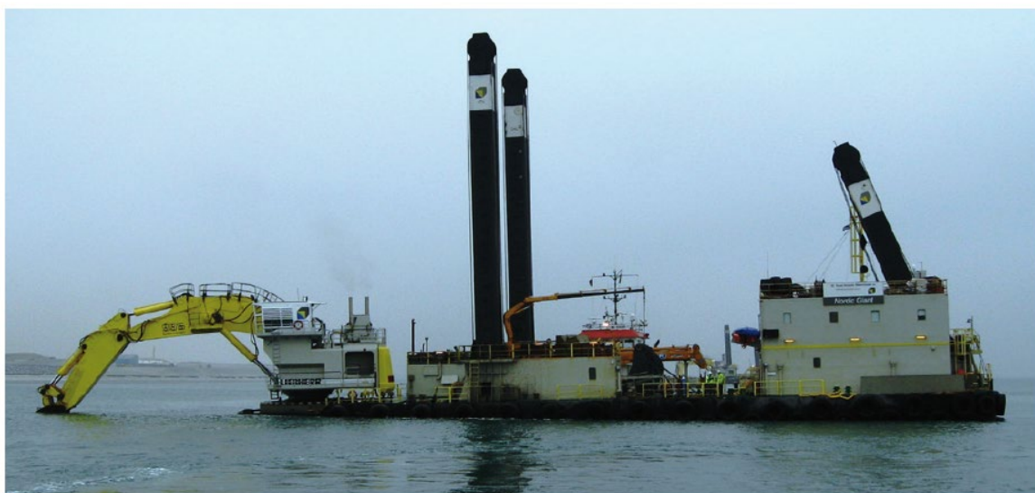
Figur 3-8 Typisk gravemaskine til nedgravning i lavvandede områder.
