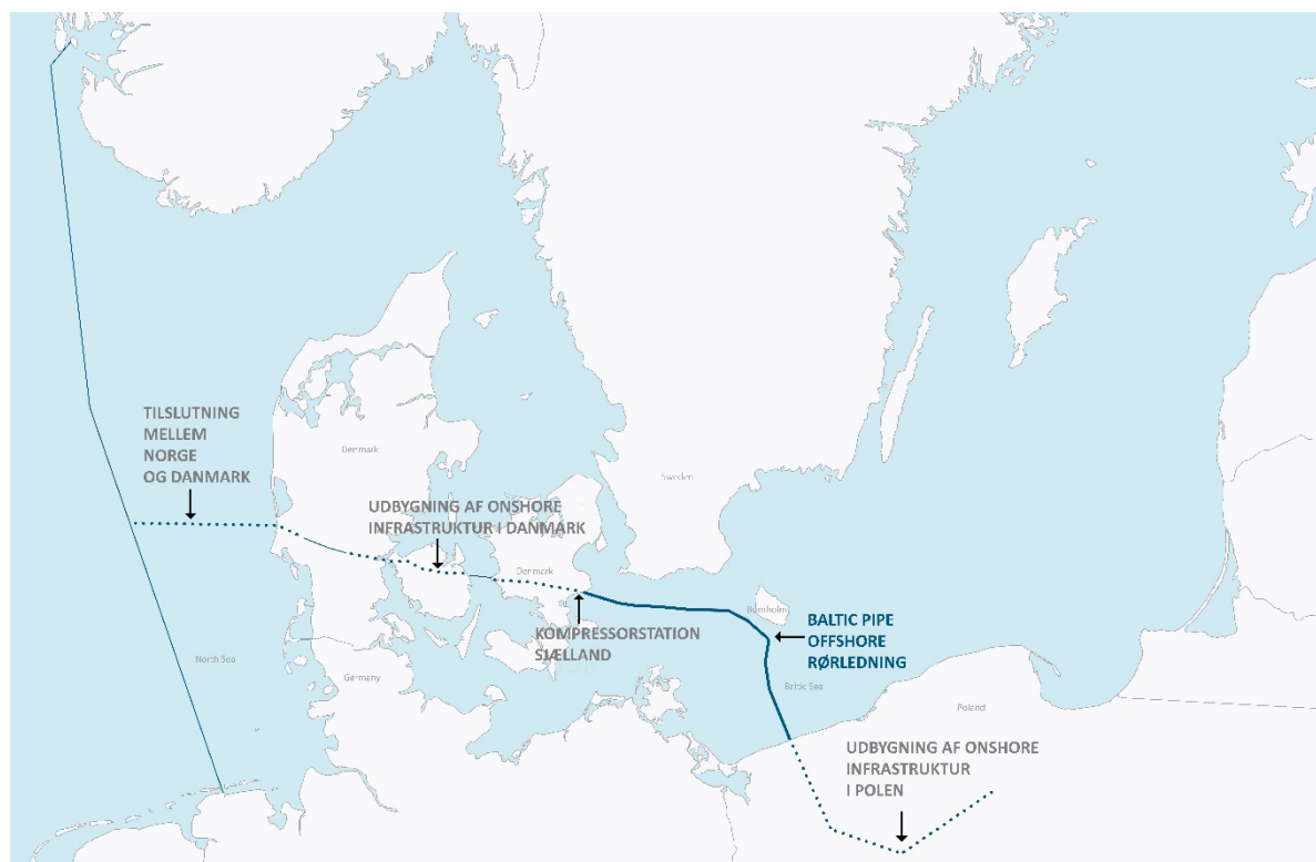
Figur 1-1 Skematisk fremstilling af de fem overordnede komponenter i Baltic Pipe-projektet.
