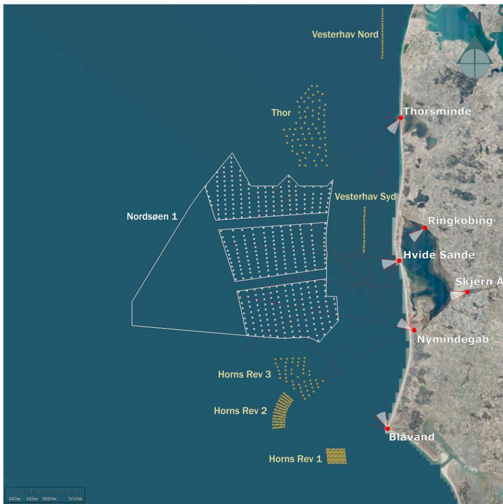
Figur 6-38 Eksisterende og fremtidige havvindmølleparker omkring planområdet Nordsøen I, som er vurderet potentielt at kunne resultere i kumulative virkninger i forbindelse med planområdet Nordsøen I. Udvalgte fotostandpunkter til principvisualiseringer er vist med røde prikker med fotoretning illustreret med grå flade. Fremtidige havvindmølleparker Nordsøen I er vist med scenarie 4, dvs. 390 havvindmøller, 27 MW. Fremtidig Thor Havvindmøllepark er vist med scenarie 1, dvs. 72 havvindmøller, 14-15 MW. Vesterhav Nord Havvindmøllepark og Vesterhav Syd Havvindmøllepark er vist, som de p.t. bliver etableret. Eksisterende Horns Rev 1 Havvindmøllepark, eksisterende Horns Rev 2 Havvindmøllepark og eksisterende Horns Rev 3 Havvindmøllepark er vist som etableret.
