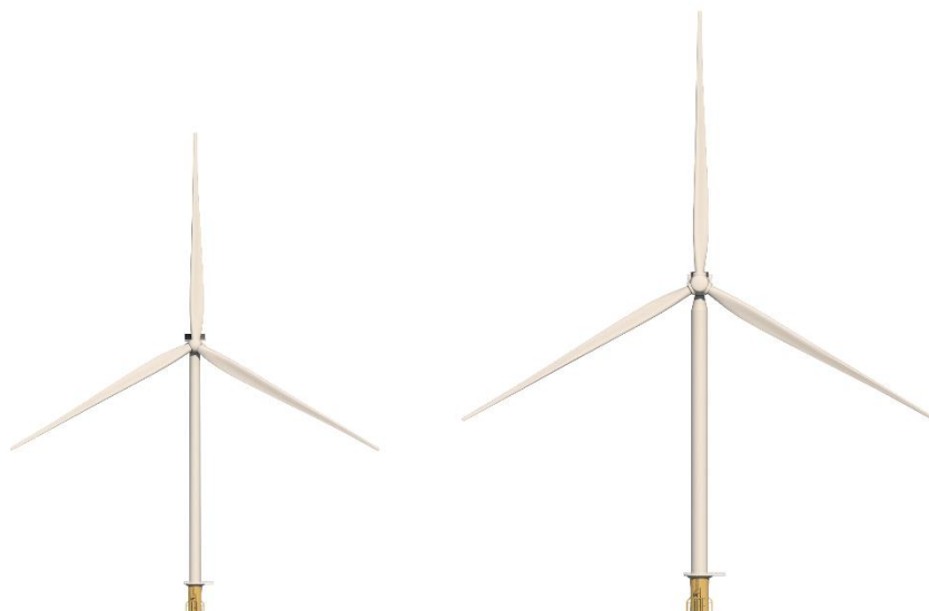
Figur 3-6 Havvindmøller anvendt til principvisualiseringer. Til venstre: 15 MW (totalhøjde 263 m, navhøjde 146,5 m, roterdiameter 233m). Til højre: 27 MW (totalhøjde 330 m, navhøjde 180 m, roterdiameter 300 m).
