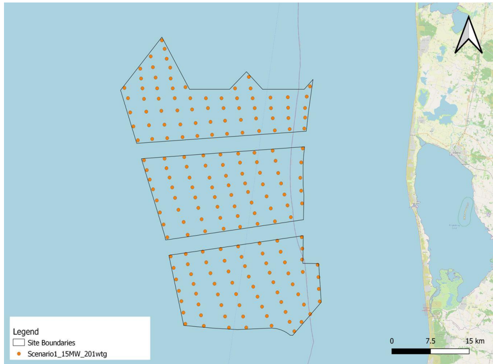
Figur 3-2 Scenarie 1 – 201 havvindmøller, 15 MW, totalhøjde 263 m (samlet 3 GW) (basis).
