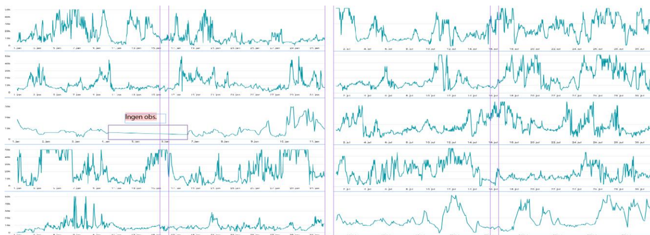
Figur 6-1 Eksempel på data om sigtbarheden for en 5-årig periode i Thyborøn. Læses figuren oppefra og ned ses observationer fra 2018 i første række, hvorpå observationer fra 2019-2022 følger i anden-femte række. Læses figuren fra venstre mod højre viser de første to kolonner en vintermåned (januar) og de sidste to kolonner en sommermåned (juli). Alt i alt ses store daglige variationer samt perioder uden målinger.
