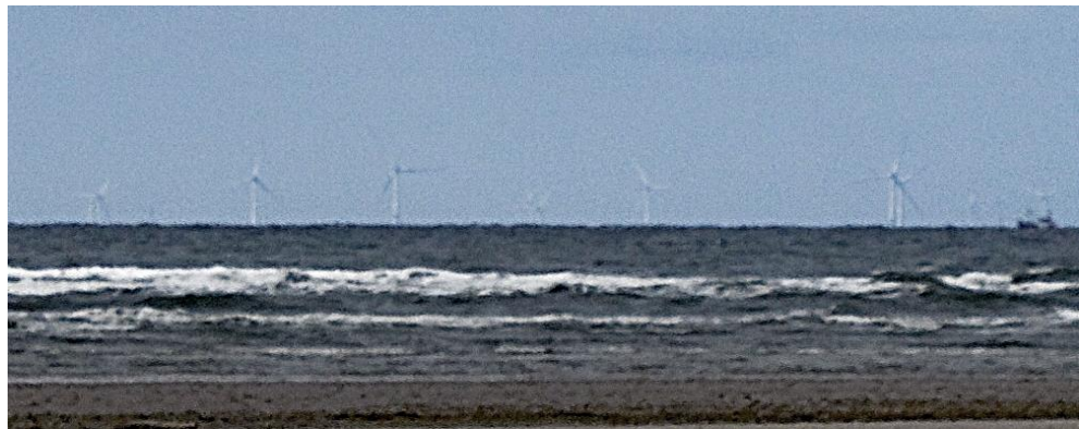
Figur 5-2 Som et helt generelt eksempel på effekten af jordens krumning på synlighed ses ovenfor et udsnit af et foto taget fra Blåvandshuk, hvor betragteren ser havvindmøllerne ved Horn Rev 3 med nærmeste havvindmøller på ca. 25 km's afstand og fjerneste havvindmøller på ca. 40 km's afstand. Betragteren ser havvindmøller på ca. 40 km's afstand som stående under horisonten. Havvindmøllernes højde til havvindmøllehuset er angivet til 105 m, og deres totalhøjde er angivet til 187 m. På 40 km's afstand og med øjenhøjde i kote 4 m, kan det beregnes, at der er "fjernet" ca. 85 m af havvindmøllerne pga. jordens krumning.
