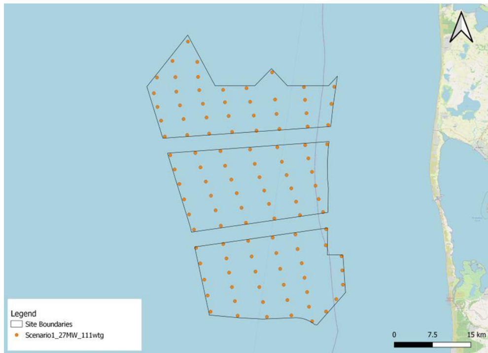
Figur 3-3 Scenarie 2 – 111 havvindmøller, 27 MW, totalhøjde 330 m (samlet 3 GW) (basis).
