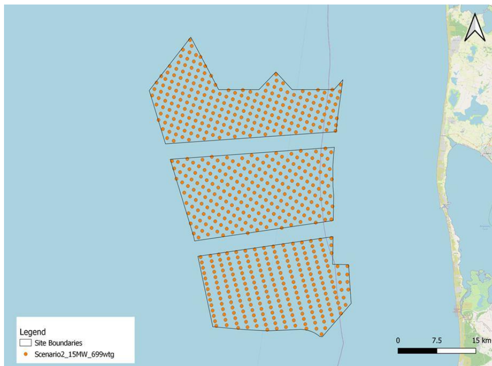
Figur 3-4 Scenarie 3 – 699 havvindmøller, 15 MW, totalhøjde 263 m (samlet 10,47 GW) (overplanting).
