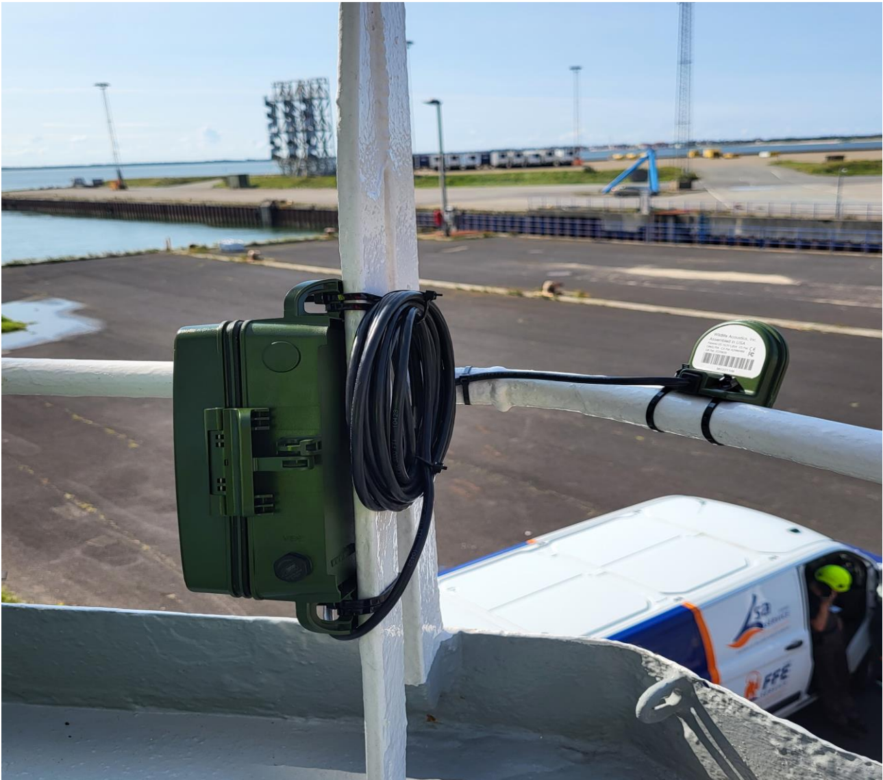
Figur 24.1: Placering af lytteboks med flagermusdetektor og mikrofon (hvh. til venstre og højre i billedet) på et af de to forundersøgelsesfartøjer, der gennemførte havbundsundersøgelser til Thor Havvindmøllepark i september, oktober og november 2023. Foto: Rasmus Bisschop-Larsen.
