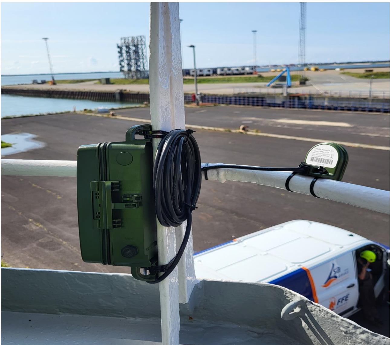
Figur 2.1: Placering af lytteboks med flagermusdetektor og mikrofon (hhv. til venstre og højre i billedet) på et af de to forundersøgelsesfartøjer under havbundsundersøgelser til Thor Havvindmøllepark i september 2023.
