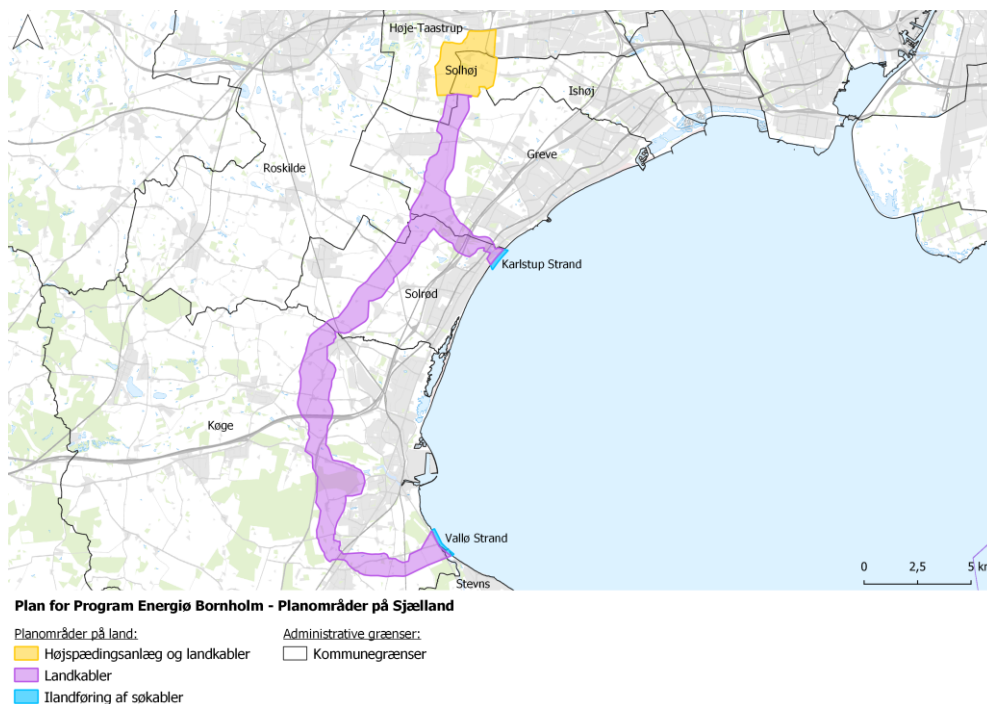
Figur 6 Områder i Plan for Program Energiø Bornholm til højspændingsanlæg og landkabler, landkabler og ilandføring af søkabler på Sjælland.
