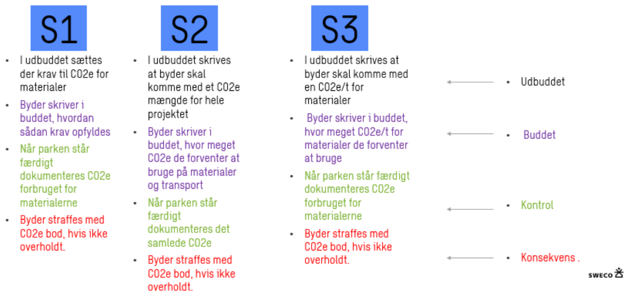
Figur 0-1: Metoder til at få bæredygtighed in i udbuddet. Med materialer menes der cement, stål og deres transport. CO2 bod anbefales umiddelbart CO2e kvoteprisen, men kan sættes højere, hvis man vil sikre grønnere tiltag.
