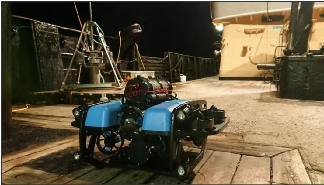
Figur 4-5. WSPs ROV - BLUEROV2 FRA BLUEROBOTICS anvendt i forbindelse med anden marin kortlægningsopgave.
