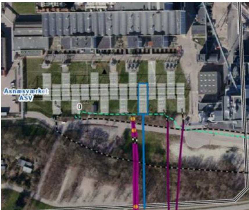
Figur 2 132 kV tilslutningsfelt ved Asnæsværket.
