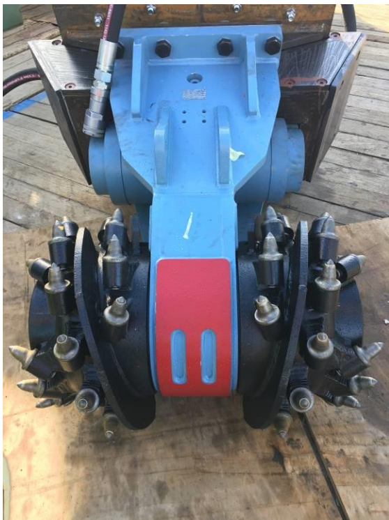
Figur 11 Fræser til neddeling af betonfundamenter
