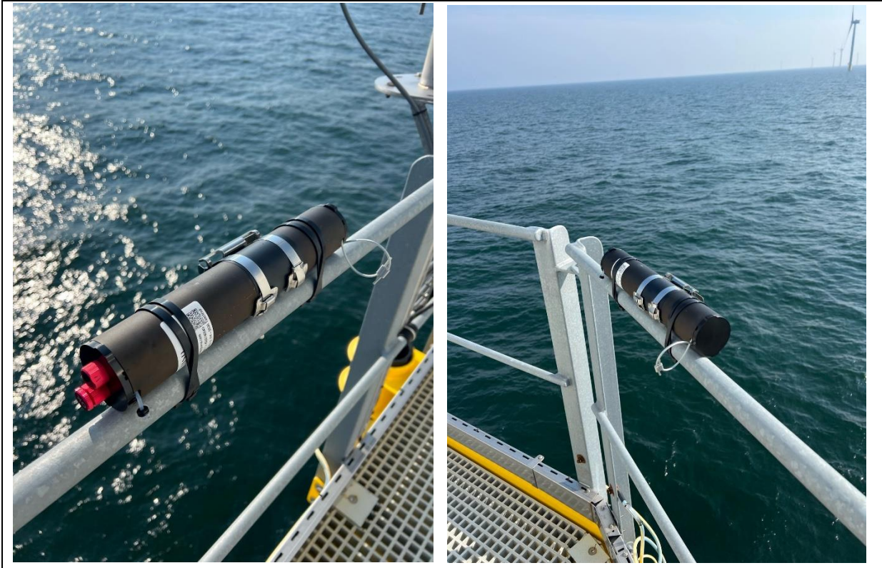
Figur 2 – SeaBat 2.0 detektorer monteret på gelænderet på møllerne ca. 5 meter over havet. Mikrofonen er som udgangspunkt omnidirektional, hvilket betyder at signaler fra flagermus opfanges i alle retninger. Selve detektoren og mølletårnet gør dog at detektorer primært vil opfange flagermus der passerer i området syd for møllen (se nedenstående skitse).
