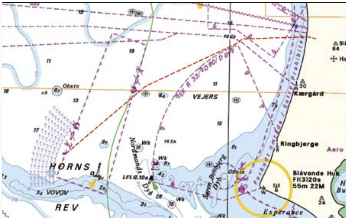
Figur 5.1.3 150 kV forbindelsen fra transformeren ved havmølleparken til kysten ved Blåbjerg, hvor et landkabel sikrer forbindelsen til højspændingsnettet. 150 kV forbindelsen er illustreret som en rød stipleet linie.
