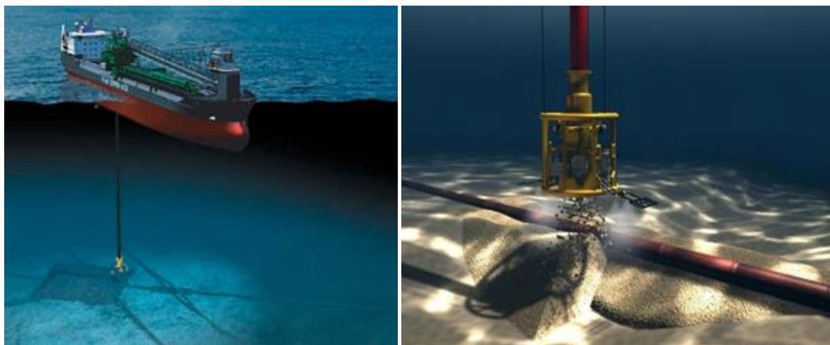
Figur 6-19 Placering af sten på havbunden gennem et faldrør.
