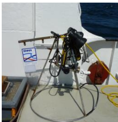
Figur 7-2 Prøveudtagning af havbundssediment blev foretaget ved hjælp af videokamera (til venstre) og HAPS-prøvetager (til højre).
