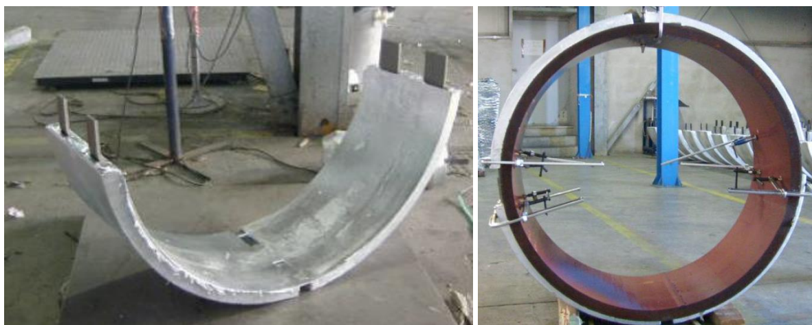
Figur 6-10 Armbåndsanode. Venstre: en halvskal; Højre: to halvskaletter prøvetilpasset til et rør.
