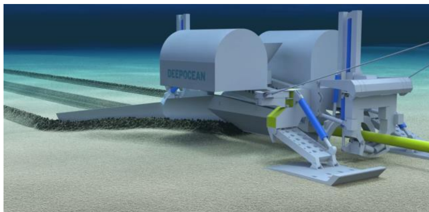
Figur 6-21 Nedgravning efter rørlægning. Typisk rørledningsplov i drift på havbunden.
