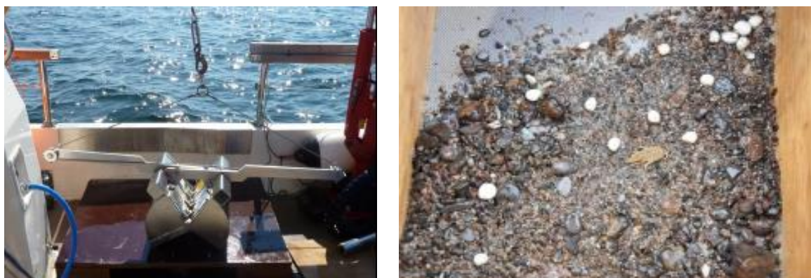
Figur 7-4 Prøvetagning af infauna blev foretaget med Van Veen-prøvetager (til venstre). Et eksempel på en infauna-prøve (til højre).
