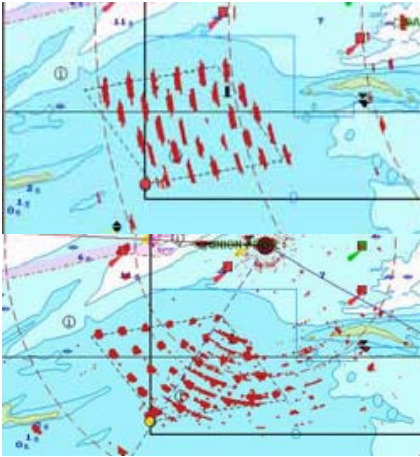
a) Skyggevirkning (øverst) og scatterrefleksion (nederst) fra havmøllerne ved Kentish Flats set på skibsradar.
