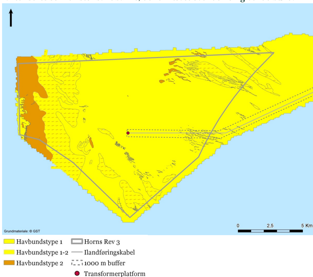
Figur 11.14. Projektområdet har en ensartet struktur og kun i den vestligste del af området på kanten til større dybder har bunden en lidt grovere struktur. I den sydvestligste del findes et lille område med forekomst af blokke, som er identisk med vraget af en pram lastet med sten.
