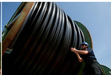
Kabeltromle med ca. 1.450 m kabel. Kabeltromlen kan veje op til 25 tons.
