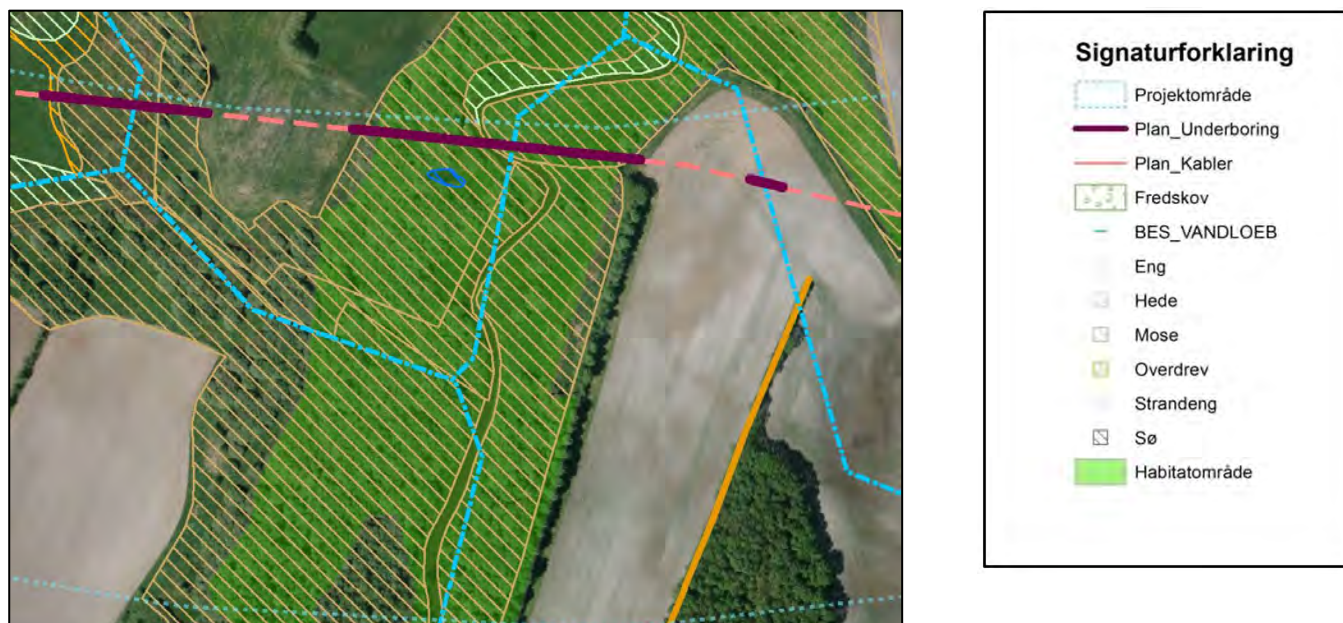
Figur 6: Forventet kabelføring i Natura 2000-område nr. 90 Sneum Å og Holsted Å nord for Endrup. Kort fra anlægsbeskrivelsen udarbejdet af Energinet.dk.
