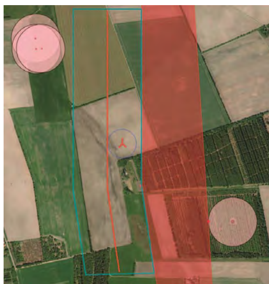
Figur 5.2. (Til højre) Det planlagte udvidede kabeltracé (blå ramme) for det alternative forslag ligger parallelt med kabelkorridoren for Horns Rev 2 kablet (rødt) gennem vindmølleområdet ved Bækhed plantage (Varde Kommune, 2013)
