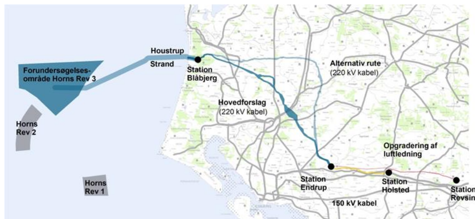
Figur 2.1 Linjeføring på land, der viser hovedforslag og alternativ rute. Der er desuden angivet strækningen Endrup – Revsing, hvor der er planlagt opgradering af luftledning.
