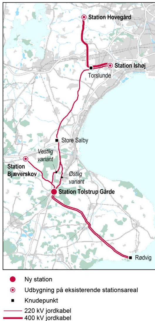
Figur 2-7 Forslag A (hovedforslaget) for det nye landanlæg omfatter en ny station ved Tolstrup Gårde. På figuren er også angivet knudepunkter, som er geografiske fikspunkter, der kan anvendes til at orientere sig på den ca. 100 km lange kabelstrækning.
