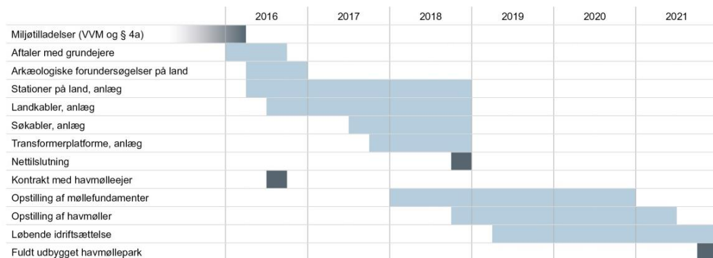
Figur 2-13. Overordnet tidsplan for anlægsaktiviteterne på land og til vands og idriftsættelsen af Kriegers Flak Havmøllepark efter der er udstedt VVM-tilladelse.
