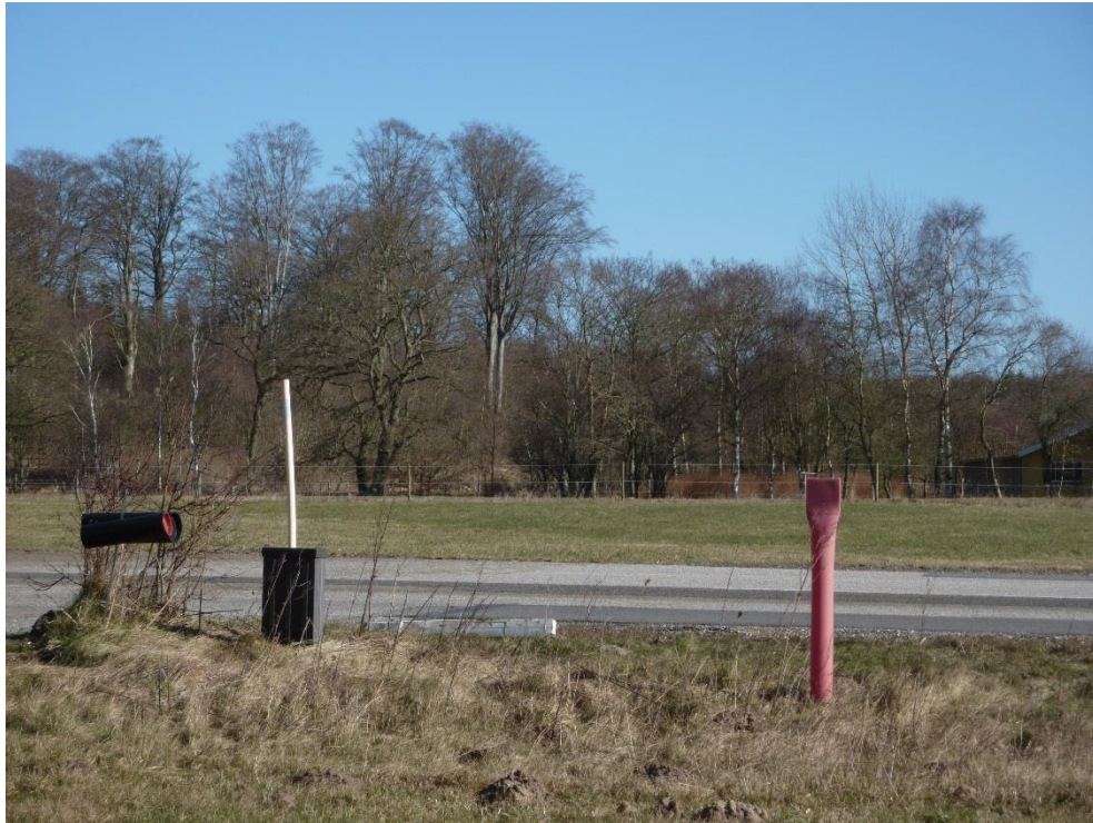
Figur 3-5. Eksempel på en markeringspæl, der viser, at der ligger et kabel i jorden.
