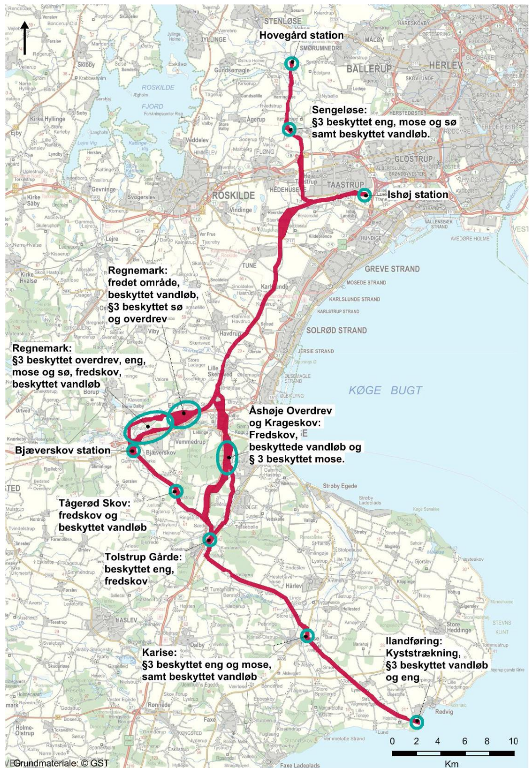
Figur 5-10 Fokusområder for natur vist for forslag A og forslag B. Ved disse fokusområder er der set detaljeret på muligheden for underboring og/eller finjustering af linjeføringen for kablet, så det helt kan undgås at berøre naturinteresserne. Disse hensyn er allerede indarbejdet i projektets design.
