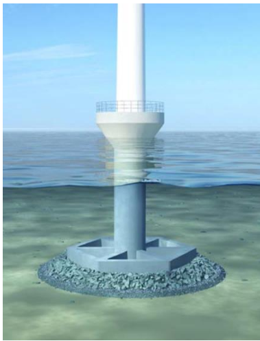
Figur 1-6. Principskitse af gravitationsfundament. Fundamentet til venstre består af et betonfundament fyldt med sand eller sten. På havbunden rundt om fundamentet er der etableret erosionsbeskyttelse af sten. Til højre ses et konisk gravitationsfundament, som er fyldt med sand eller andet tungt materiale (Energinet.dk, 2015b).
