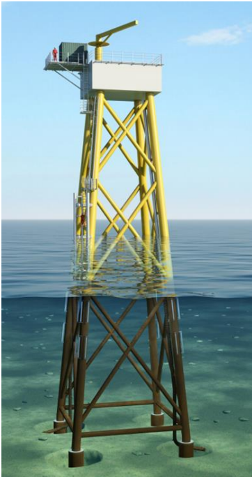
Figur 1-7. Principskitse af jacketfundament (Energinet.dk, 2015b).
