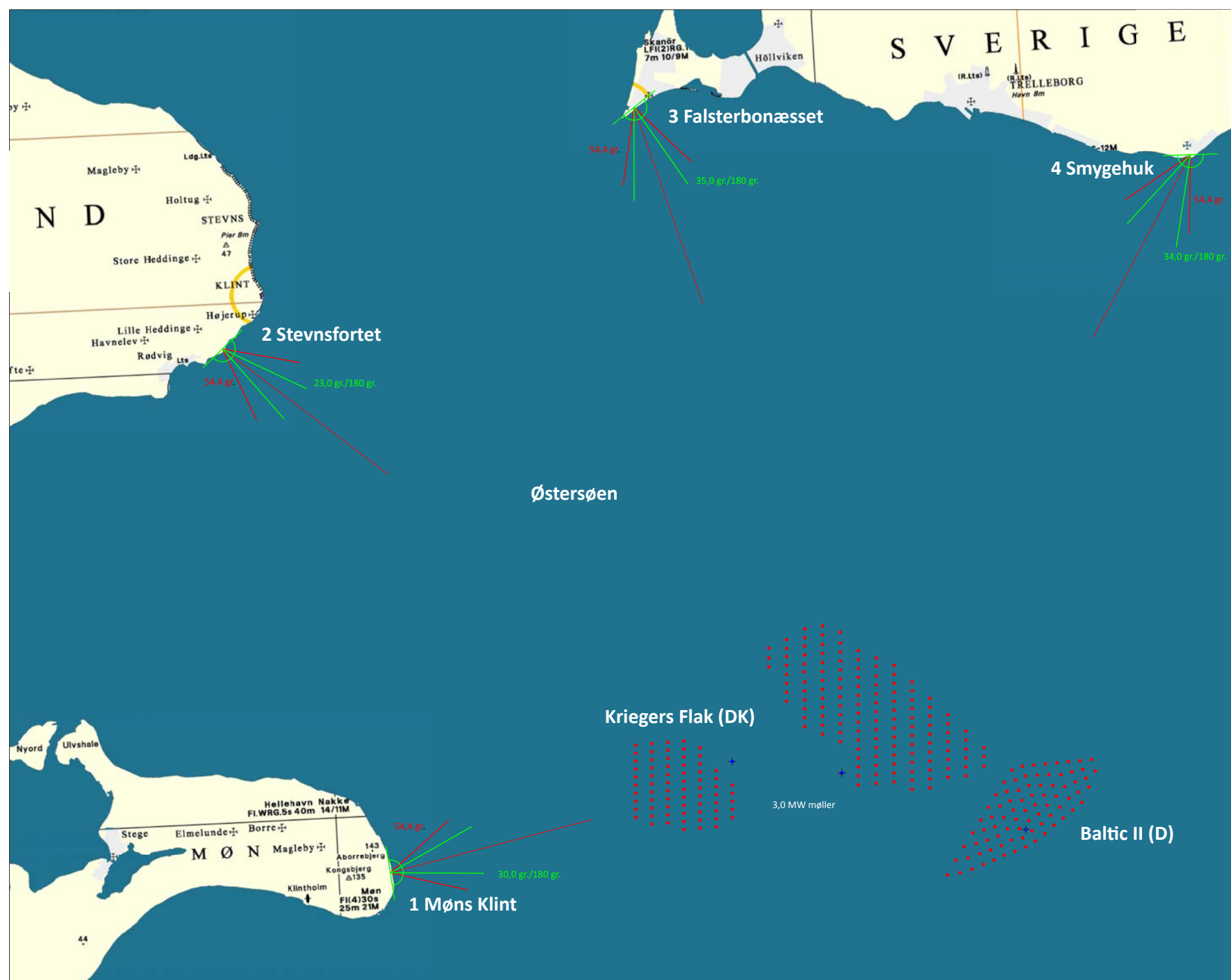
Fig. 19. Oversigtskort over visualiseringspunkter med tilhørende billedvinkler (rød) og angivelse af den del af horisonten, der optages af havmøllerne (grøn). Udbredelsen af møllerne er uafhængig af møllernes størrelse. Her er vist 3 MW møllerne. 10 MW møllerne har samme udbredelse. Som det ses, optages en større del af horisonten set fra Sverige. Til gengæld ses flere møller liggende bag hinanden set fra Danmark.
