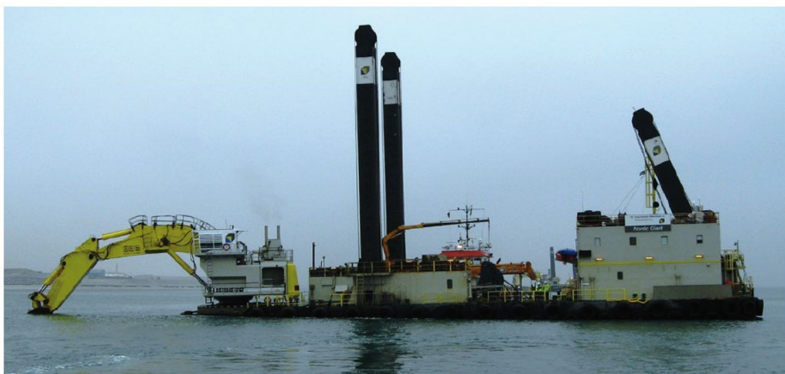
Rys. 4-3 Typowa pługiębiarka podsiębierna do prac wykopowych na płytkich wodach.
