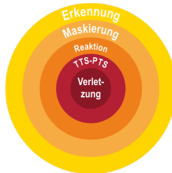
Abbildung 7-8 Einflusszonen in verschiedenen Entfernungen von einer Unterwasserlärmquelle (WODA, 2013).
