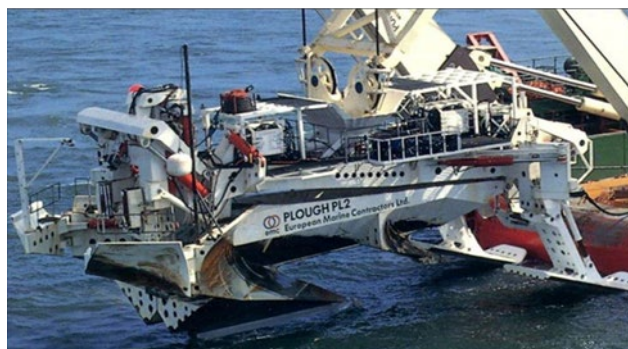
Abbildung 3-10 Pipelinepflug vor dem Absenken vom Schleppschiff auf den Meeresboden (links) und schematische Darstellung eines Grabenaushubs mit Pflügen (rechts).
