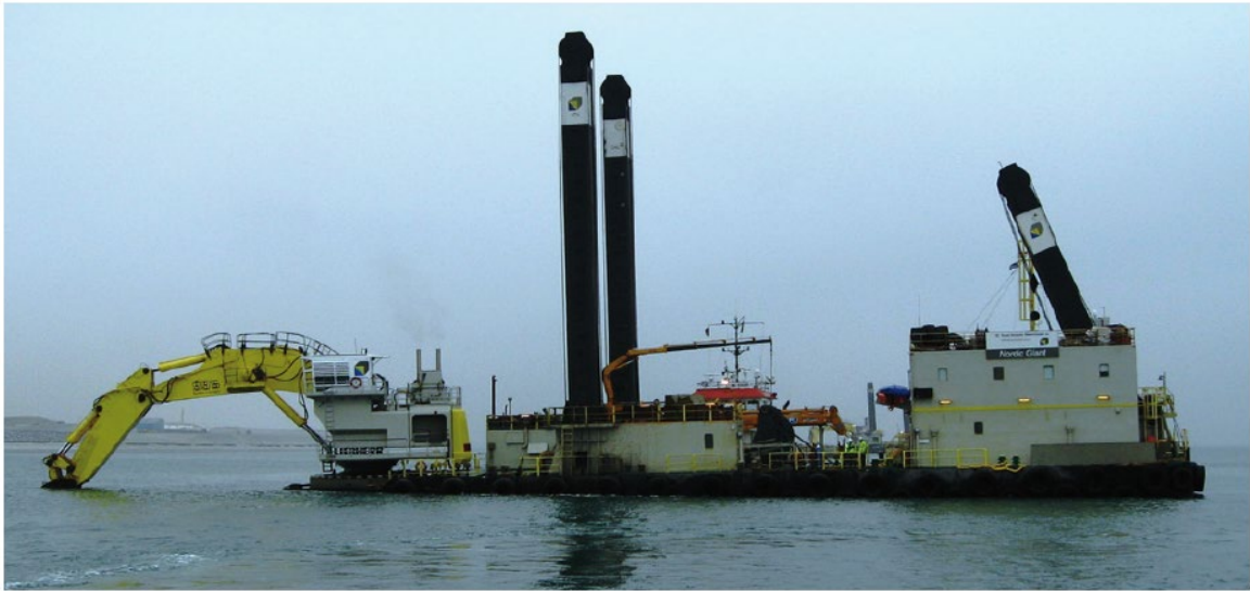
Abbildung 5 Typischer Tieflöffelbagger auf Stelzenponton für den Aushub im flachen Wasser
