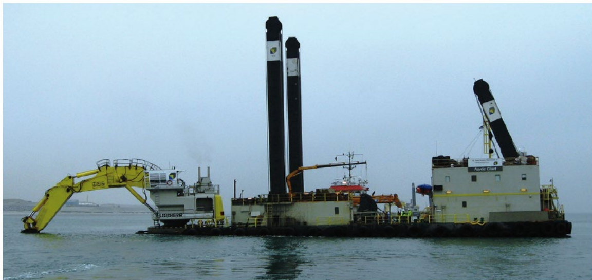
Abbildung 3-8 Typischer Tieflöffelbagger auf Stelzenponton für den Aushub im flachen Wasser.
