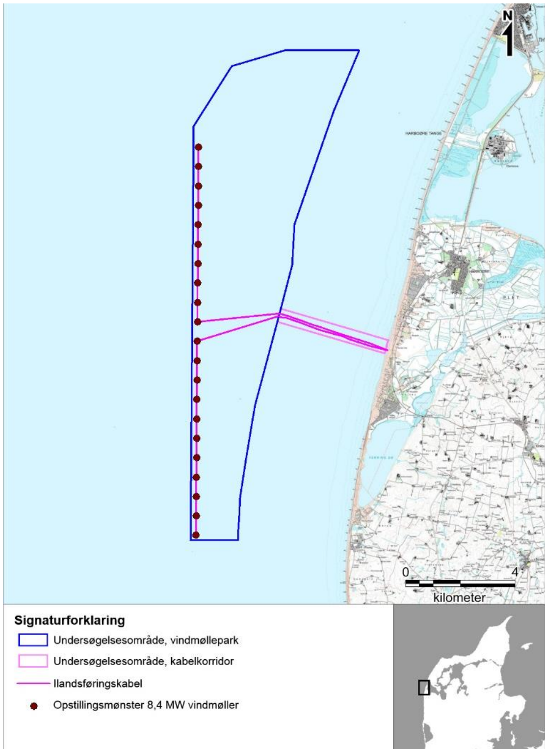
Figur 1-1. Figuren viser opstillingsmønsteret for vindmølleprojektet Vesterhav Nord. Den viser også det område, hvor Vattenfall må placere møllerne. Det er samtidig det område, hvor der er udført mange undersøgelser af miljøet (koncessionsområdet / undersøgelsesområdet).
