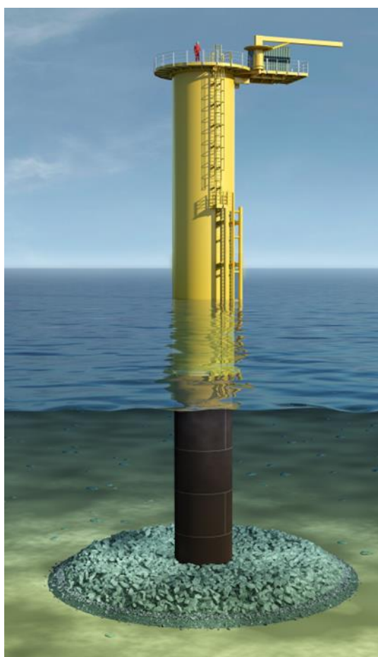
Figur 3-2. Eksempel på et monopælfundament. Fundamentet består af et stålrør, der er rammet ned i havbunden samt et gult overgangsstykke. På havbunden rundt om fundamentet er der etableret en erosionsbeskyttelse af sten. Illustration: Rambøll. (Energinet.dk, 2015a).
