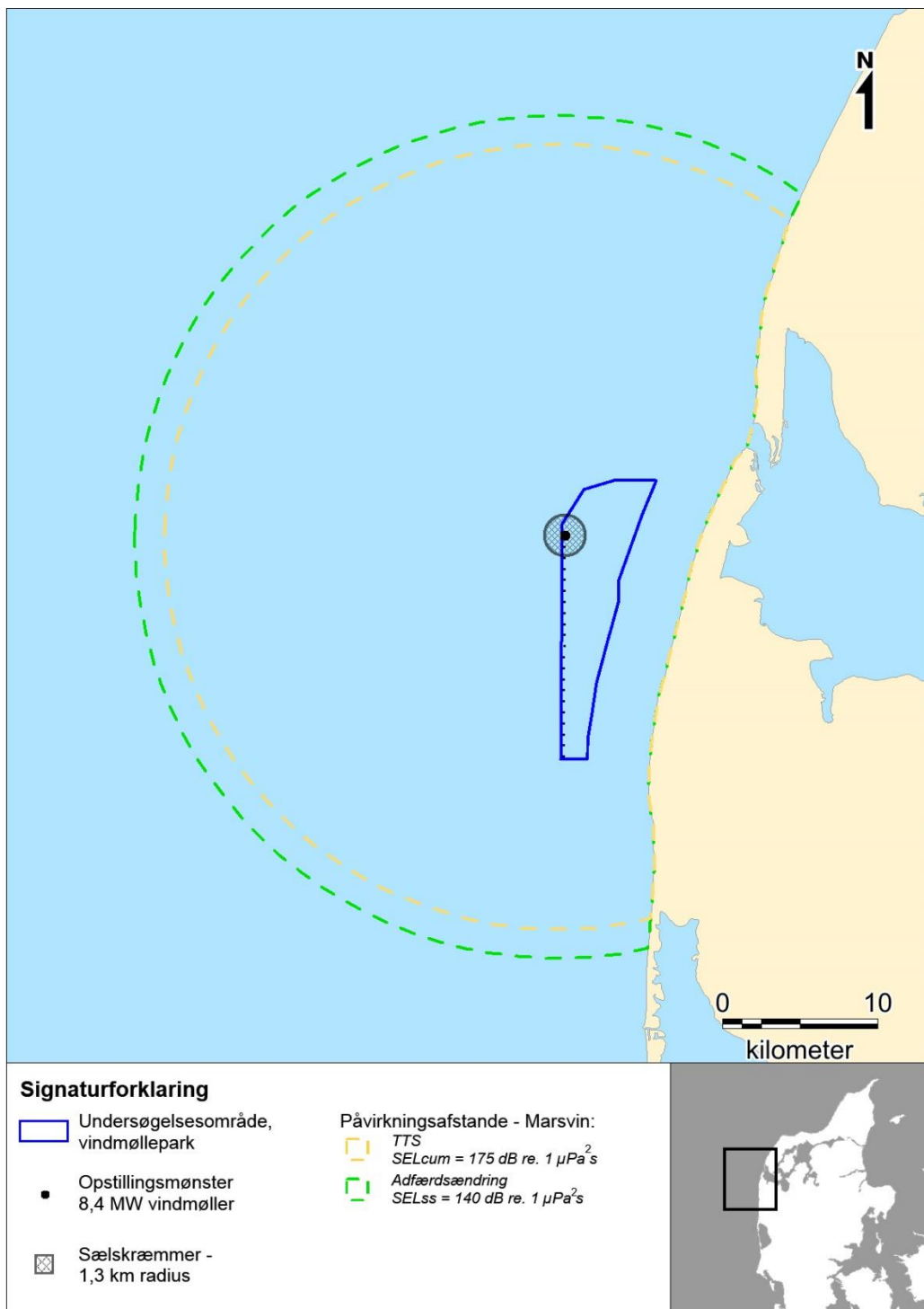
Figur 5-26. Påvirkningsafstande for nedramningsstøj for marsvin ved nedramning på mølleposition nr. 01. Den gule stiplede linje angiver området, hvor der er risiko for, at marsvin udsættes for midlertidig hørenedsættelse (TTS). Den grønne stiplede linje angiver området, hvor der er risiko for, at marsvin udsættes for adfærdsændringer. Den grå skraverede cirkel angiver en diameter på 1,3 km omkring nedramningspunktet svarende til bortskræmningsafstanden for sælskræmmeren på marsvin. Undersøgsområdet for indeværende miljøkonsekvensvurdering er vist med mørkeblå, mens de 21 møller ved Vesterhav Nord er angivet med prikker i den vestlige del af undersøgsområdet. Det kumulerede lydeksponeringsniveau (SELcum). Lydeksponeringsniveauet for en enkelt puls/signal (SELss) (ITAP, 2019b) og Tabel 5-21).
