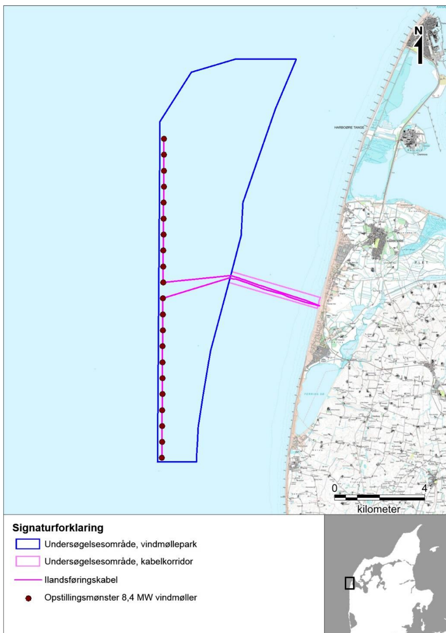
Figur 3-1. Opstillingsmønster for 8,4 MW vindmøller. I alt 21 vindmøller med en maksimal kapacitet på 180 MW placeres indenfor undersøgelsesområdet.
