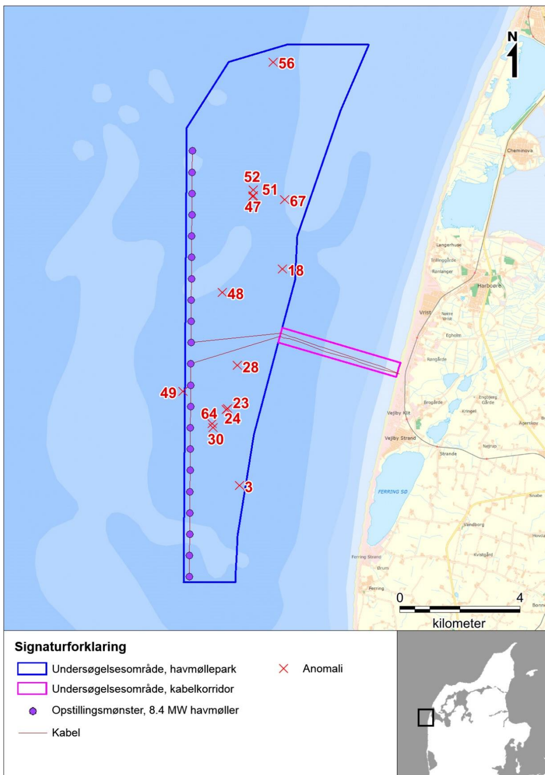
Figur 5-30. Oversigt over anomalier identificeret på baggrund af de geofysiske data i undersøgelsesområdet (Strandingsmuseum St. George, 2014b).
