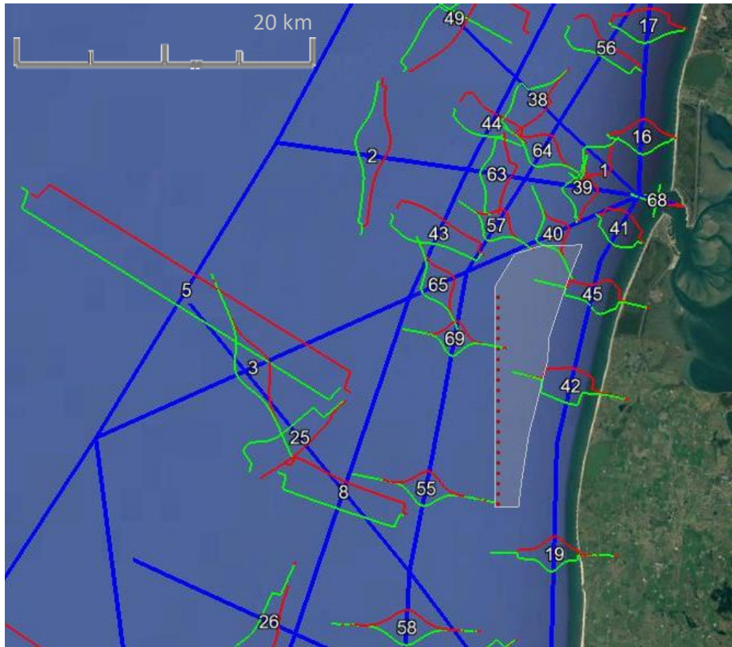
Figur 5-9 Endelige ruter omkring møllerne og deres statistiske beskrivelse (blå linje = endelige ruteben, rød stiplede linje = oprindelige ruteben, røde/grønne kurver = skibenes tværgående fordeling i hver deres sejlretning).
