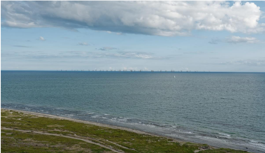
Figur 4-18 Eksempelvisualisering fra Sønderbjerg, hvor Hesselø Havvindmøllepark er illustreret med 20 MW møller svarende til en totalhøjde på 310 meter. En stor del af det fokuserede synsfelt (svarende til billedet) er udfyldt med møller. Omfanget på vandfladen er derved meget stort. (NIRAS A/S 2024c)
