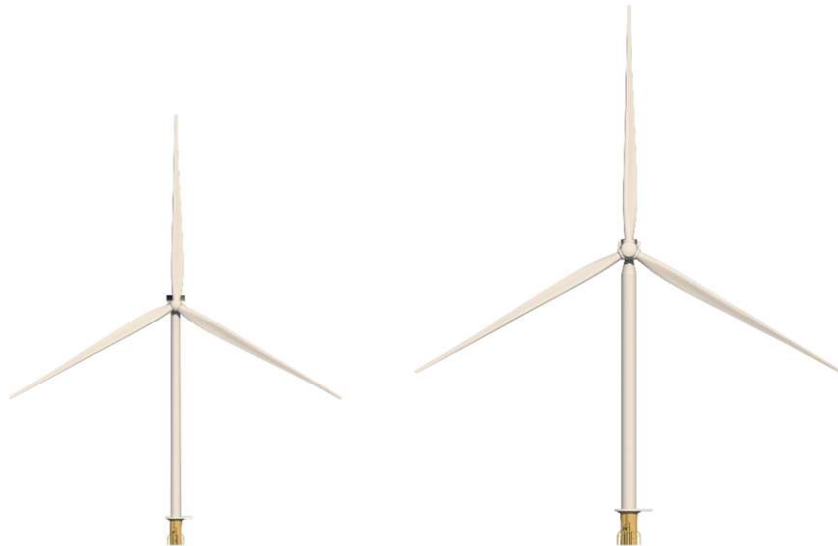
Figur 3-5 Havvindmøller anvendt til principvisualiseringer. Til venstre: 15 MW (totalhøjde 263 m, navhøjde 146,5 m, roterdiameter 233m). Til højre: 27 MW (totalhøjde 330 m, navhøjde 180 m, roterdiameter 300 m).
