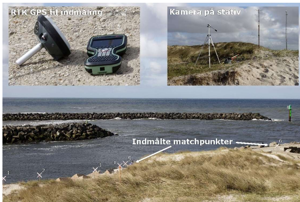
Figur 9-1 Øverst til venstre: RTK-GPS til indmåling af kamera og kontrolpunkter. Øverst til højre: DSLR-kamera på stativ. Nederst: Opstilling af landmålerpinde, der bruges til kameramatch. For at finde den brændvidde, som fotoet skal tages med og den retning, som fotoet skal tages i, opstilles landmålerpinde foran kameraet i den retning, som havvindmølleparken kommer til at ligge. Opstillingen opmåles med RTK-GPS. Den indmålte opstilling kan ses både i 3D-modellen som GPS-punkter og i fotoet og skal matche for at få et gyldigt kameramatch.
