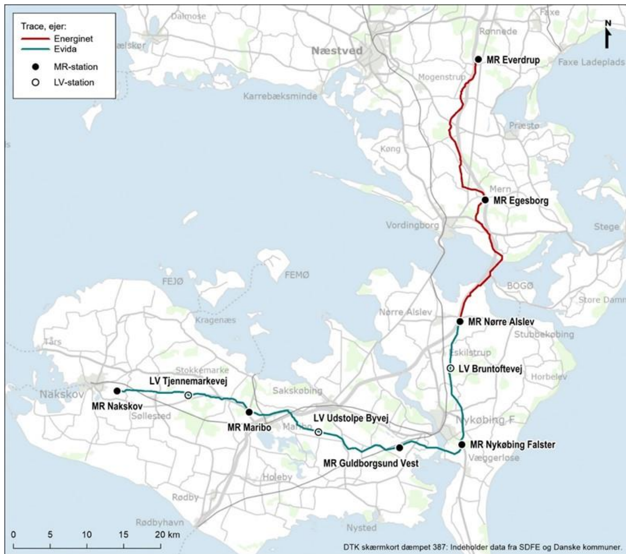
Figur 5-1 Linjeføring for gasrørledningen for Grøn Gas Lolland-Falster mellem Everdrup og Nakskov. Placeringen af de syv MR-stationer og tre LV-stationer fremgår også. Den røde strækning, nord for Nørre Alslev ejes af Energinet. Den grønblå strækning, syd for Nørre Alslev ejes af Evida.
