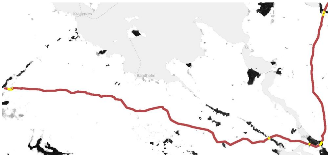
› › Figur 15-4 Resultat af analysen hvor de 5 steder hvor gravearbejde i den 1,5 meter dybe ledningsgrav fjerner dele af den nitratbeskyttende reducerede ler (vist med gul). Disse områder er uden for NFI-områder. Rød viser ledningsgrav.
