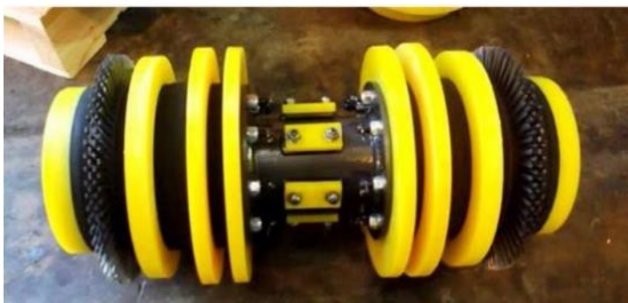
Figur 5-18 Eksempel på "rensegrise", der sendes gennem gasrørledningen for at rense for eventuelle urenheder.
