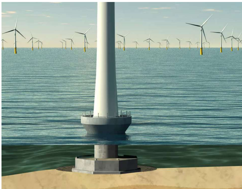
Figur 3-10 Typisk design af gravitationsfundament.
