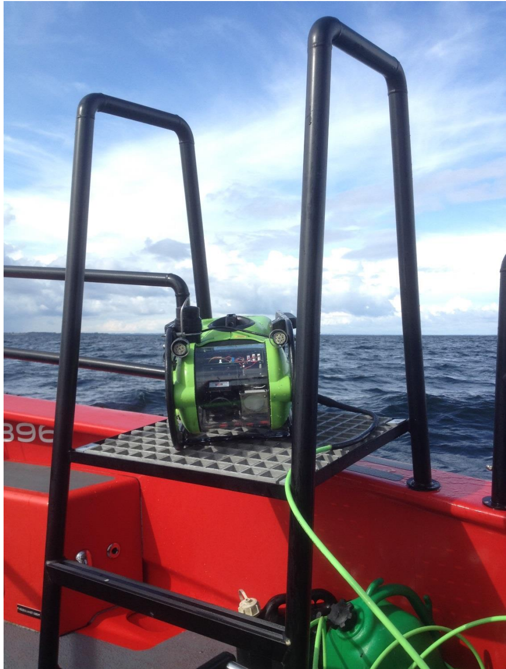
Figur 7 ROV klar til verifikationsdyk på Eleanor. Foran ses kameralinse og lys. Fartøjet styres med joystick fra skibet via det grønne kabel.
