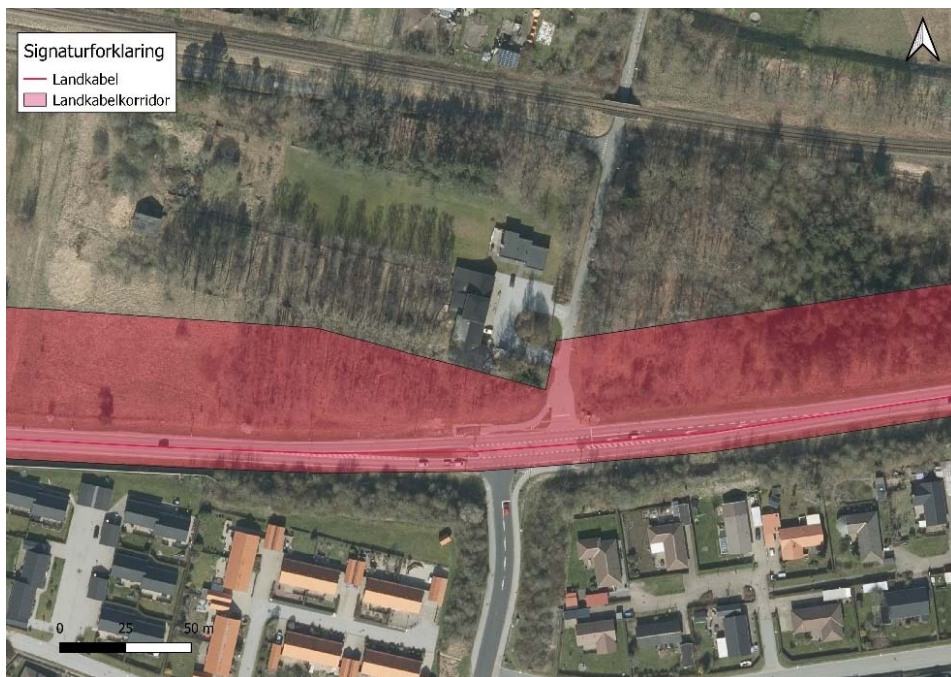
Figur 2.3: Vestlige del af kabelkorridor indsnævret ved bebyggelse.
