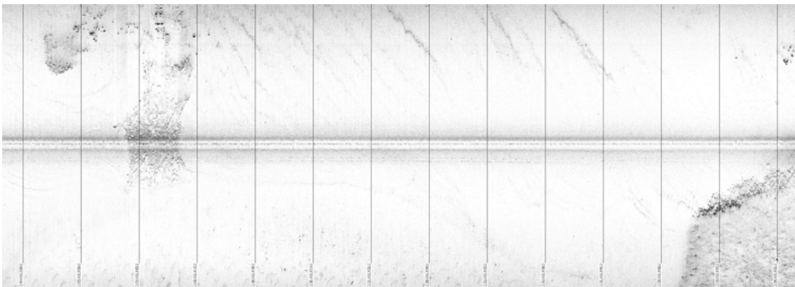
Figur 6.11 Udsnit af Side scan sonar data, Fred_2, med tegn på dynamisk mobilt sand på havbunden.
