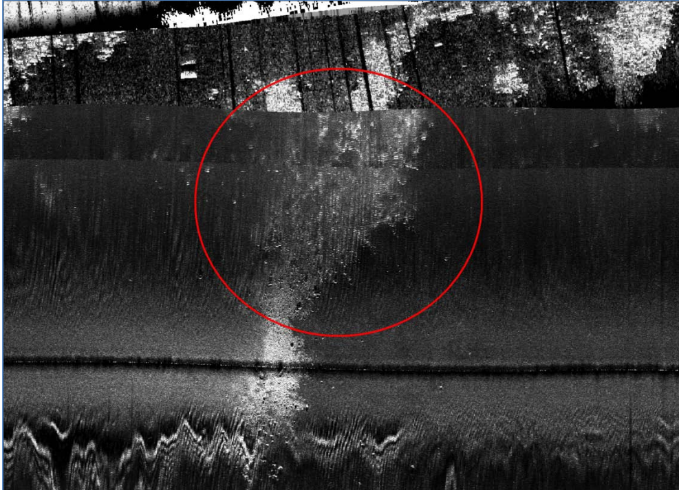
Figur 8: Sidescanbillede fra området ud for Frederikshavn Havn. Bredden på billedet er 250 meter. I cirklen ses grus, småsten og spredte større sten (substrattype 3).
