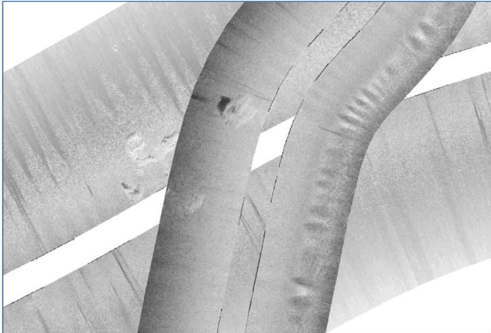
Figur 10: Sidescanbillede fra området ud for Frederikshavn Havn. Bredden på billedet er 100 meter. På billedet ses en sandet bund med det veldefinerede boblerev.
