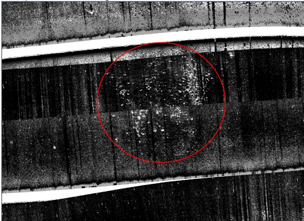
Figur 7: Sidescanbillede fra området ud for Frederikshavn Havn. Bredden på billedet er 250 meter. I cirklen findes sandbund med varierende indslag af sand, grus og småsten (substrattype 2).
