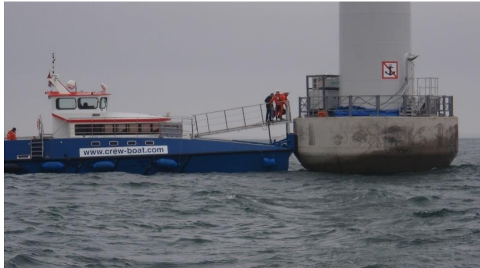
Figur 4.6: Eksempel på en vedligeholdelsesbesigtigelse af en vindmølle udført vha. et besætningsfartøj (CTV).
