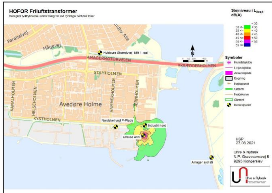
Figur 6.19: Støjbredelse fra drift af transformerstation (Uhre & Nybæk, 2021).
