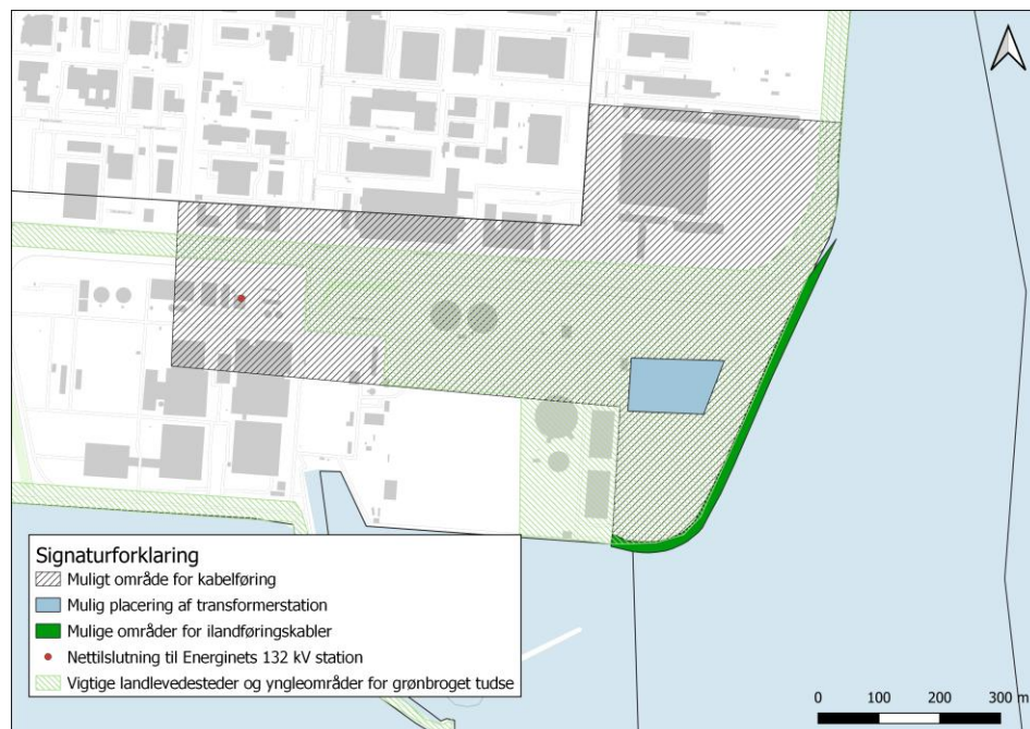
Figur 17.26: Oversigtskort over den mulige placering af transformerstationen (blå område), ilandføringskabler samt vigtige landlevesteder og yngleområder for grønbroget tudse. ©SDFE, WMS-tjeneste, Ortofoto 2020.
