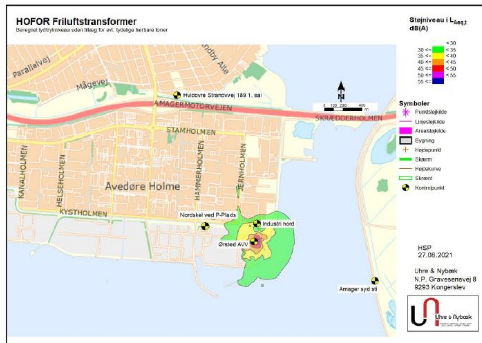
Figur 19.4: Støjudbredelse fra drift af transformerstation (Uhre & Nybæk, 2021).
