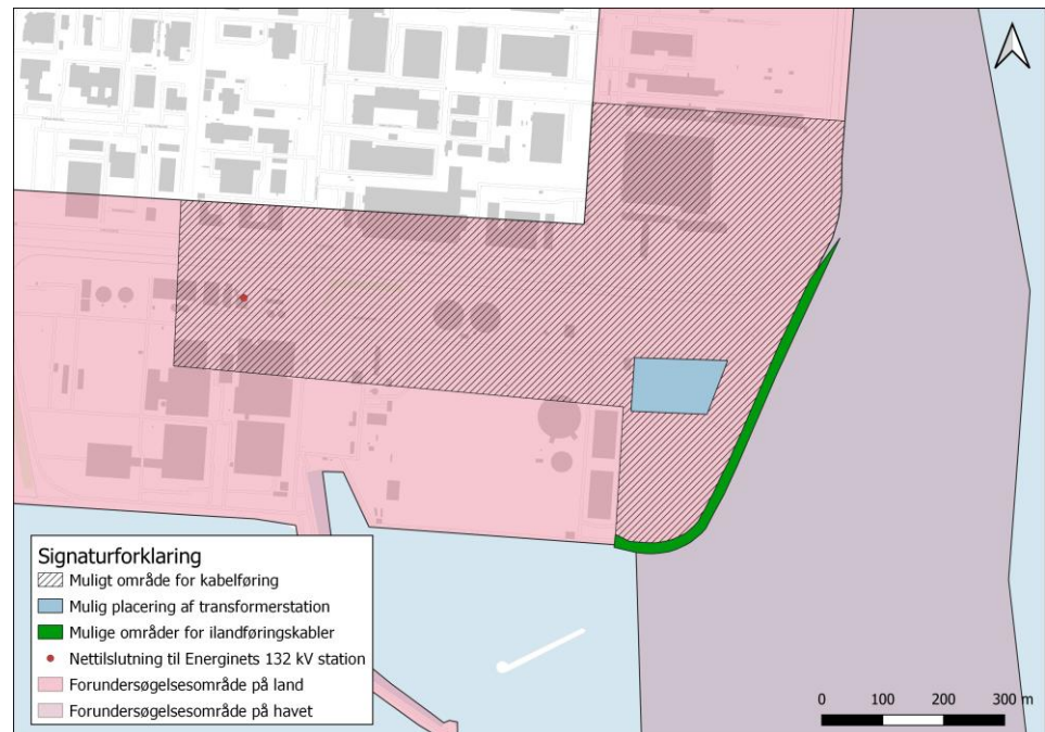
Figur 2.3: Oversigt over projektet på land, inklusive den mulige transformerstation, områder for ilandføringskabler og nettilslutningspunkt. ©SDFE
