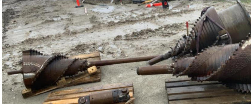
Figur 3.8: Eksempel på reamer for udvidelse af borehullet fra pilotboringen.
