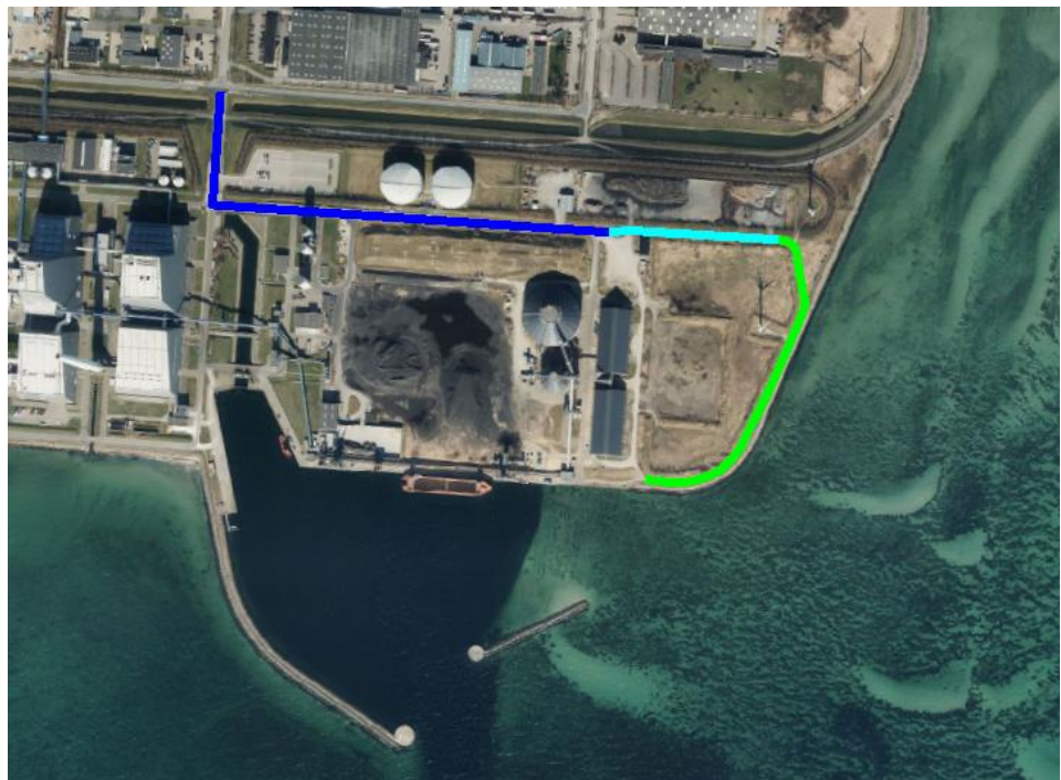
Figur 3.1: Adgangsvej til ilandføringsområdet. Blå markering angiver 7 m bred asfalteret vej, cyan markering angiver 3,5 m bred asfalteret vej og grøn markering angiver 3,5 m bred grusvej.
