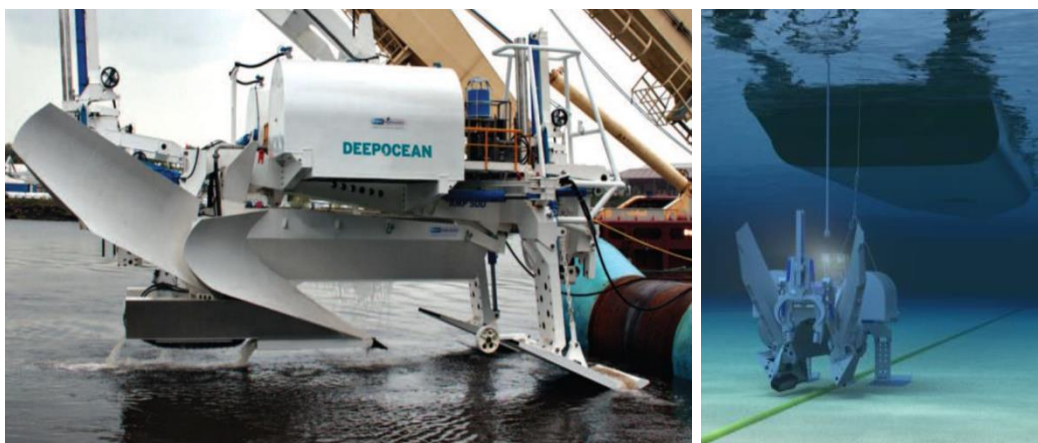
Figur 6-21 Nedgravning efter rørlægning. Typisk rørledningsplov i drift på havbunden.
