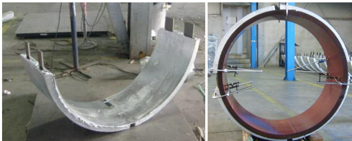
Figur 6-10 Armbåndsanode. Venstre: en halvskal; Højre: to halvskaller prøvetilpasset til et rør.
