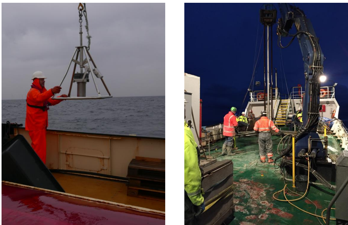
Figur 7-4 HAPS core-prøvetager til prøver af overfladesediment (til venstre) og Vibrocore-prøvetager til prøver fra dybereliggende sediment (til højre).
