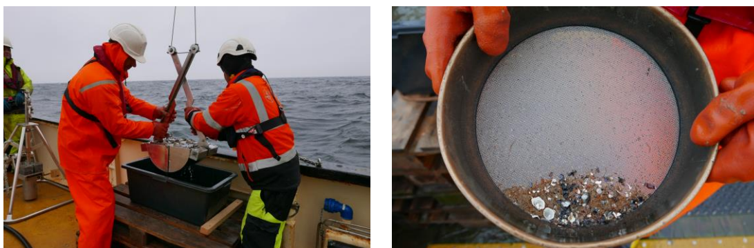
Figur 7-8 Prøvetagning af infauna blev foretaget med Van Veen-prøvetager (til venstre). Et eksempel på en infauna-prøve (til højre).
