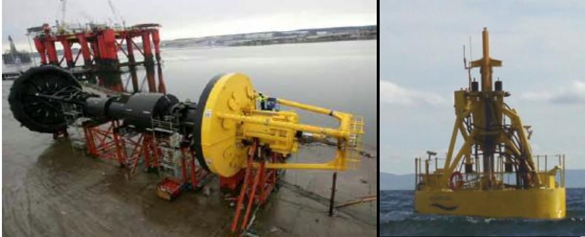
Figur 20 OPT PowerBuoy 150kW USA og Storbritannien (EMEC)[W33] og WaveBob, Irland [W34].
