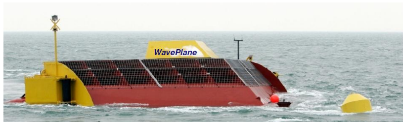
Figur 16 WavePlane 200kW bugseres til Hanstholm for placering.
