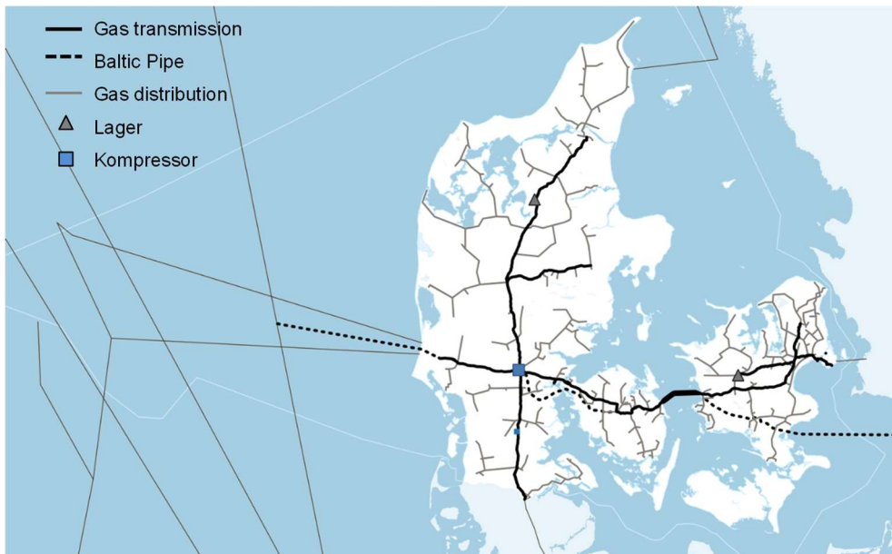
Figur 4: Gassystemet med transitforbindelser.
