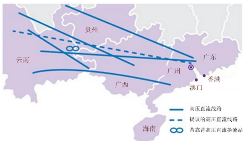
图5-1：中国南方电网的特高压基础设施 9 。
