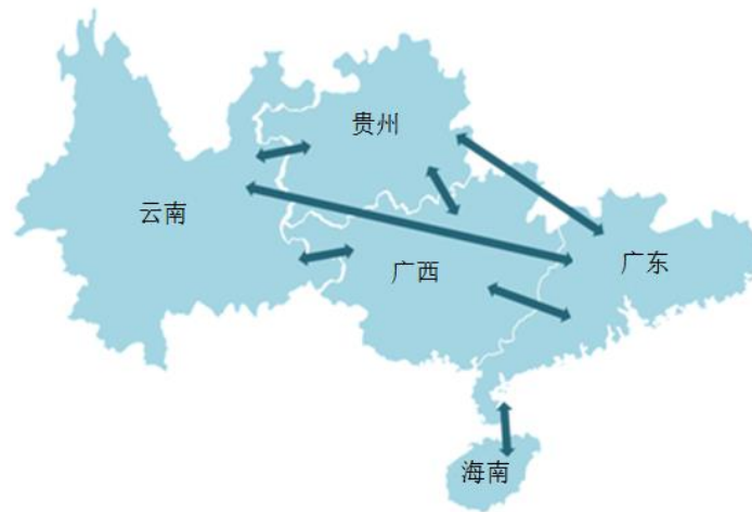
图8-4：中国南方电网覆盖范围图示。地区之间的箭头代表模型内的地区间输电系统。
