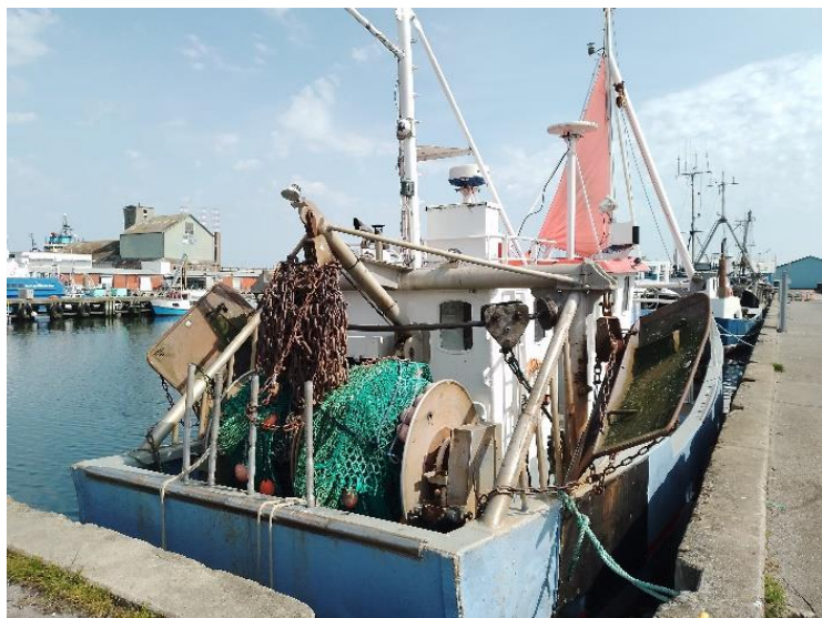
Figur 2. Hummertrawler i Grenå Havn. Bemærk 2 trawltromler, trawlskovle og kædeklump, hvortil de to trawl er forbundet.
