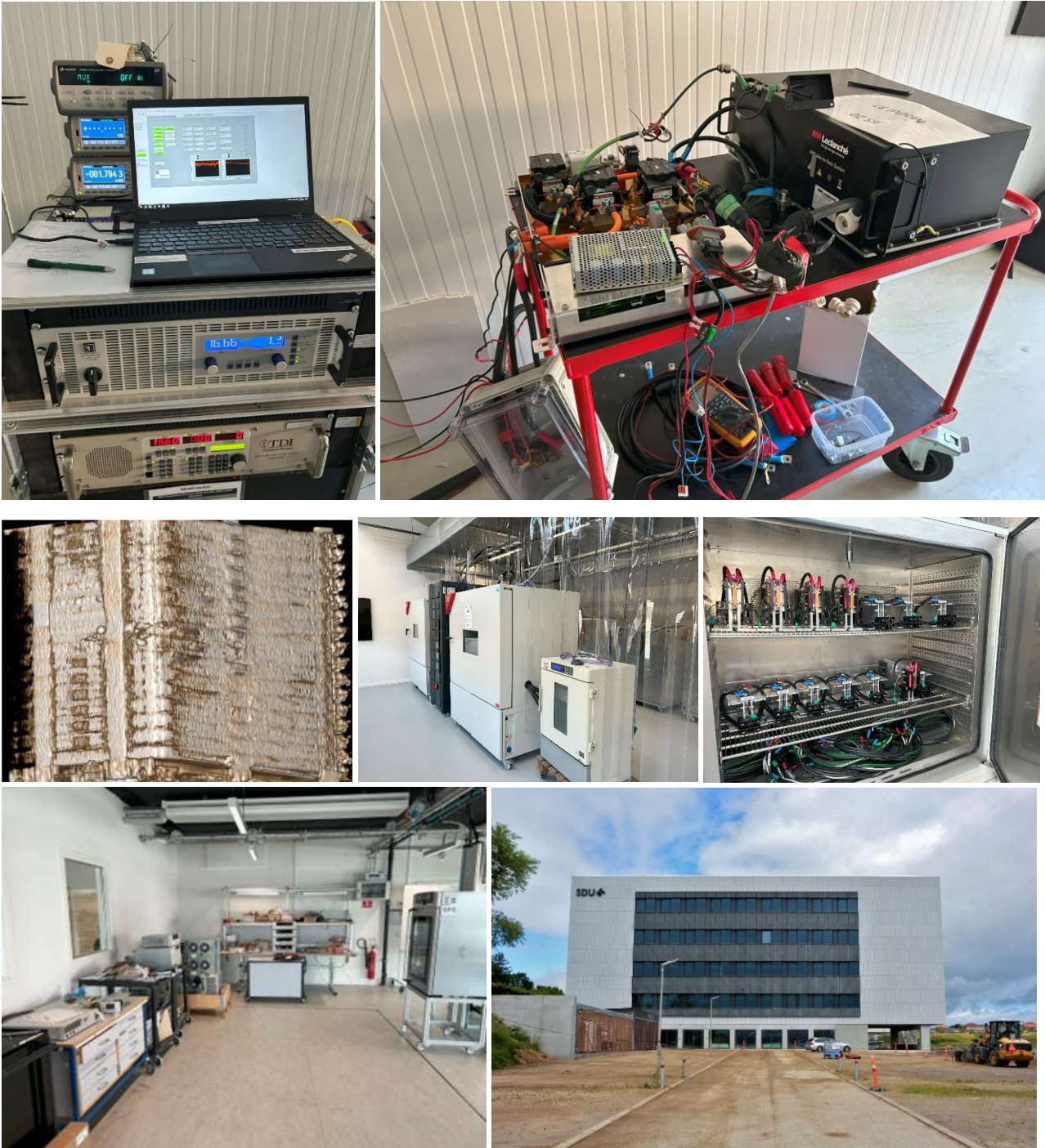
Figur 4.6 Fotos Henrik Hagbarth Mikkelsen & Gunnar Rohde, batteritest af batterimoduler fra Ellen ved DTI Århus, CT-Scanning af batterimodul ved DTI Tåstrup, testskabe med klimakontrol. CIE batterilaboratorier på SDU i Sønderborg med lignende testfaciliteter, hvor batterimoduler fra Ellen cycles og testes netop nu.
