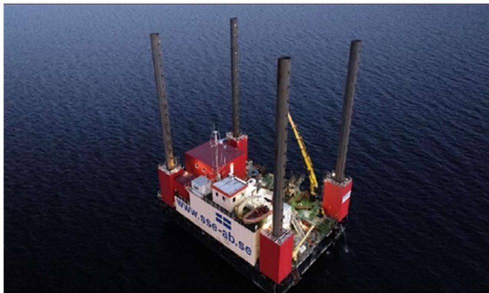
Figur 2.2: Geoteknisk boring fra Jack-up pram. Prammens 4 ben sættes på havbunden, hvorefter prammen hæves op så den står stabilt, upåvirket af bølger og strøm.
