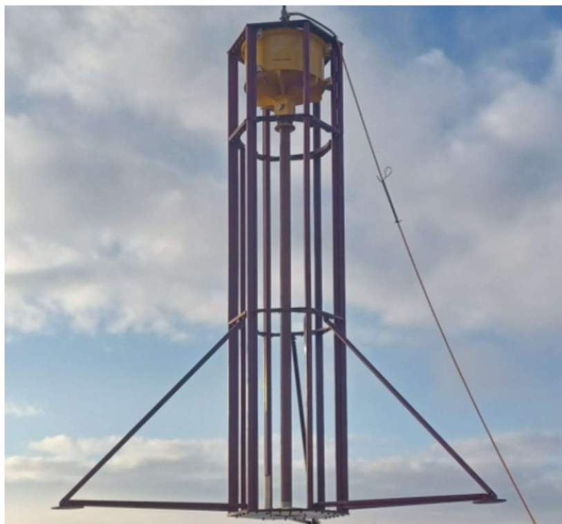
Figur 2.6: Eksempel på vibrocore monteret i ramme. Opstillingen sænkes ned på havbunden med en kran. Stålrøret vibreres ned af vibratoren, som ses monteret på toppen af stålrøret. Stålrøret har en klap i bunden, som lukkes når røret trækkes op af kranen. Ofte har stålrøret en indvendig foring af plast, som gør det lettere at tage prøvekeren ud. Det findes mange varianter af vibrocores (foto er taget fra google).
