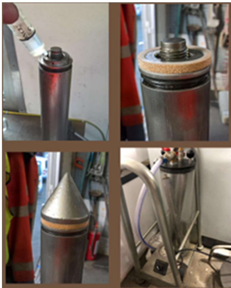
Figur 2.4: CPT-sonde. Under nedpresningen måles en række parametre, som giver data om geologien. Det orange lag under sondens spids er et filter, der anvendes til måling af trykforhold i geologiske lag, som er en af de mange parametre der kan måles med metoden. Foto: Fra GEO præsentation (hentet på google).
